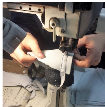
Slika 2.9. Šivanje antistatik trake
