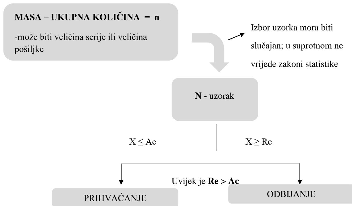
Slika 5.1. Shematski prikaz jednostrukog uzorkovanja {prema lit. r.br. 15.}
