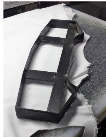
Slika 2.6. Krojenje pojačanja nadringle
