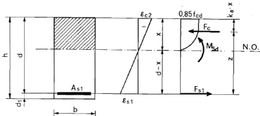
Slika 2.4. Jednostruko armirani pravokutno presjek u vlačnoj zoni
