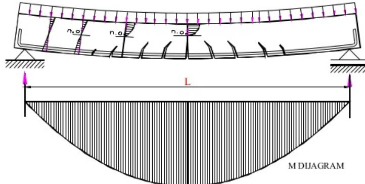
Slika 2.1. Armiranobetonska greda u kojoj je beton naprezan na tlak, a čelik na vjak
