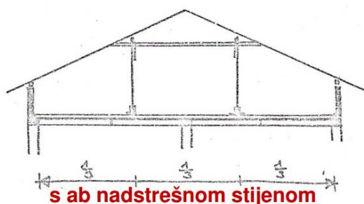
Slika 22. Kroviše s dvostrukom stolicom
