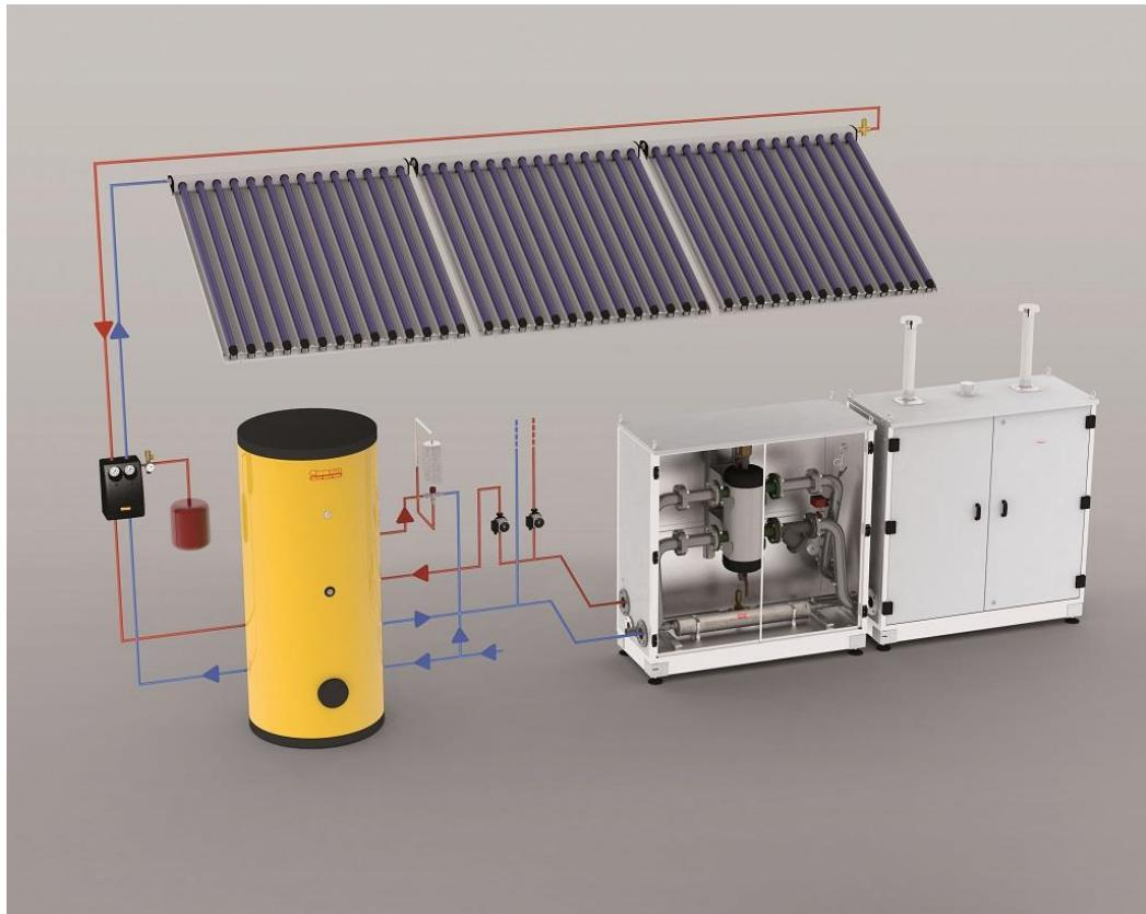
*Slika 3.1.6. Solarni sustav za grijanje i toplu vodu*
