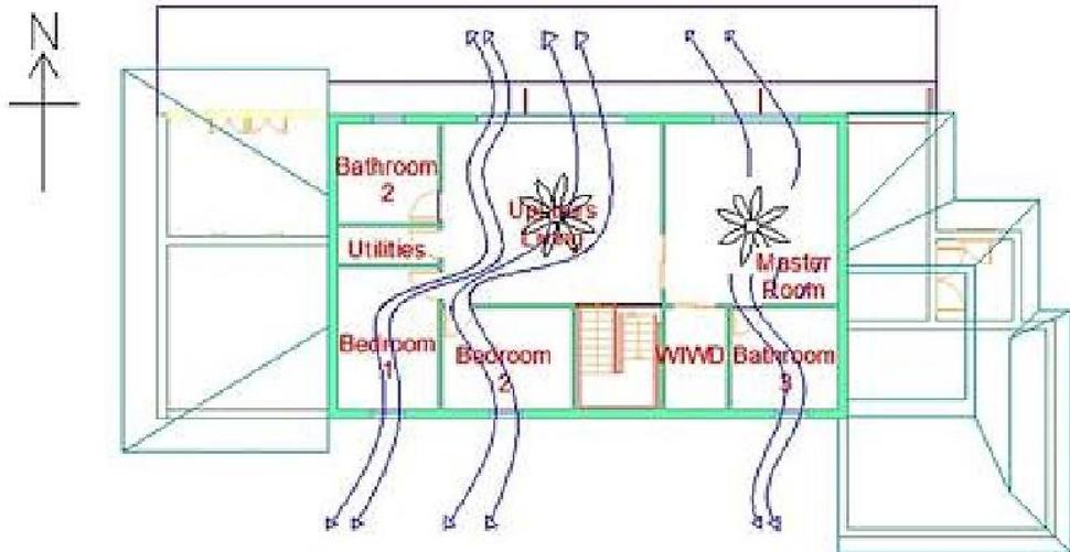
*Slika 3.2.2. Pasivna ventilacija (strujanje zraka kroz unutrašnjost kuće)*
