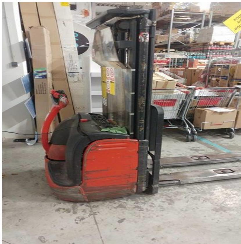
Slika 5.6.*Ručni električni viličar*
