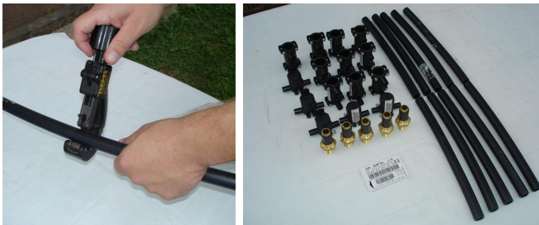
Slika 3.6. Priprema uzoraka a) rezanje cijevi na dužinu od 30 cm b) pripremljeni uzorci sa spojnim materijalom [13]
