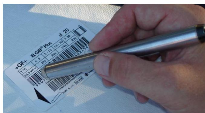
Slika 3.15. Čitanje barkoda čitačem sa magnetske kartice [13]
