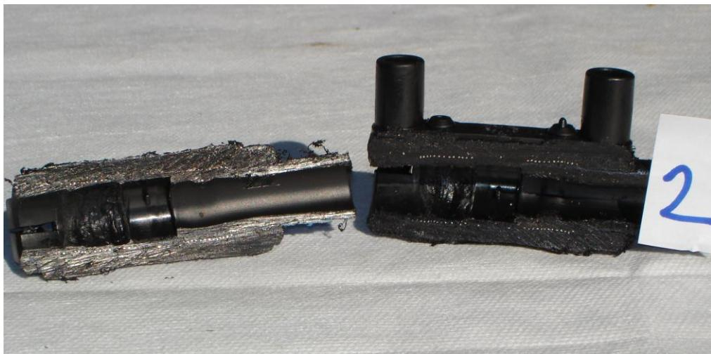
Slika 4.6. Presjek cijevi i elektrospojnice kod uzorka br.2 [13]
