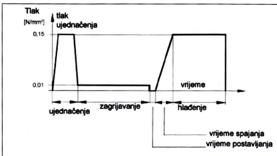
Slika 2.15. Dijagram vrijednosti tlakova tijekom sučeonog zavarivanja [4]
