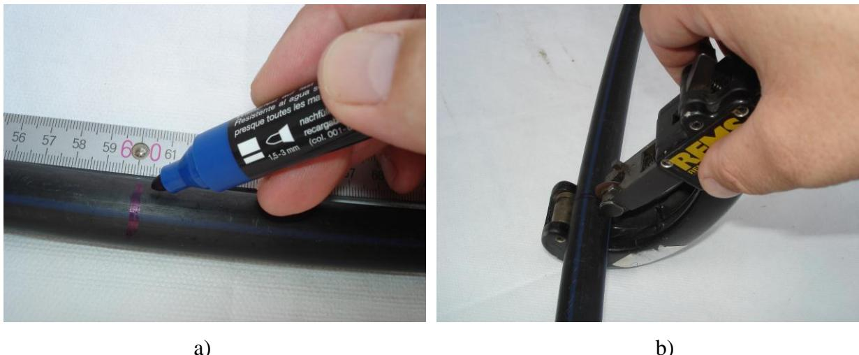
Slika 3.4. Priprema uzorka a) označavanje mesta rezanja cijevi b) rezanje cijevi sa rezačem cijevi na 60 cm [13]
