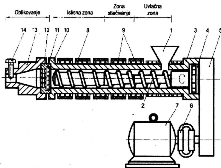
Slika 2.3. Presjek jednopužnog ekstrudera; 1-lijevak, 2-pužni vijak, 3-cilindar za taljenje, 4-tlačni ležaj, 5-namjestivi prigon, 6-spojka, 7-pogonski motor, 8-grijala, 9-hladila, 10-prirubnica, 11-sita, 12-cjedilo, 13-glava ekstrudera-mlaznica, 14-prigušnica. [1]
