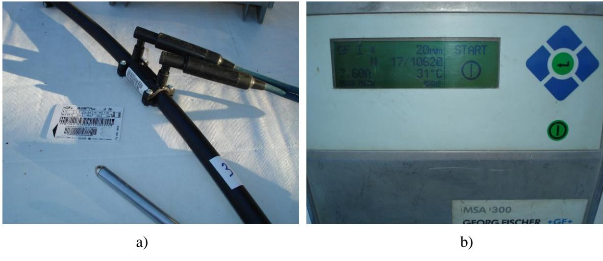
Slika 3.25. Zavarivanje uzorka br. 2 a) spajanje na kablove za zavarivanje b) prikaz podatka na zaslonu aparata očitanih sa magnetske kartice [13]
