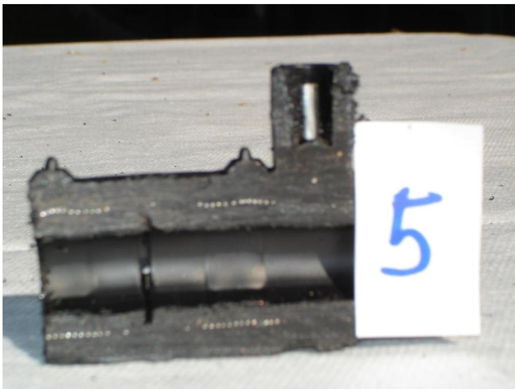
Slika 4.8. Presjek cijevi i elektrospojnice kod uzorka br. 5 [13]
