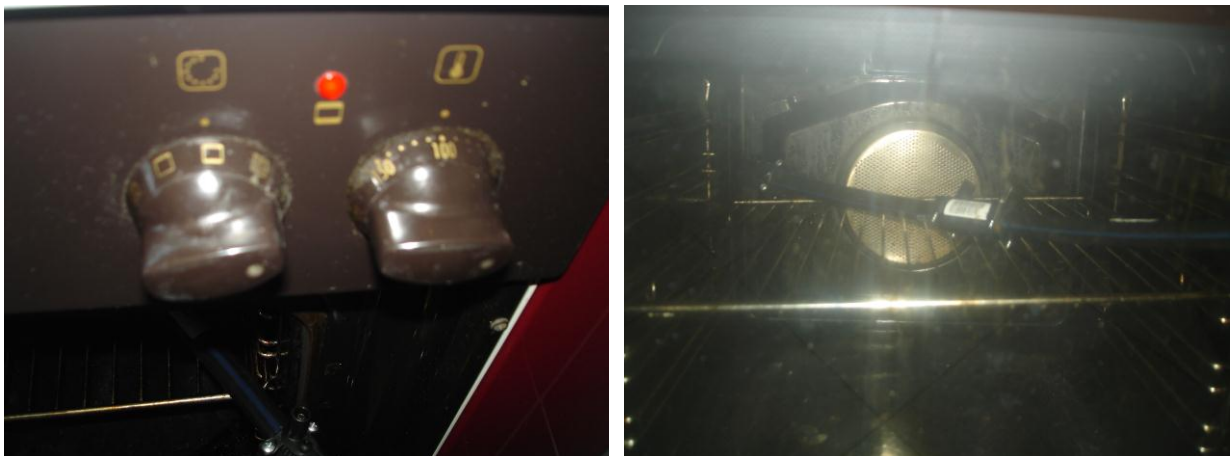
Slika 3.29. Priprema uzorka br. 5 za zavarivanje a) stavljanje uzorka u pećnicu i podešavanje pećnice na 100 °C b) zagrijavanje uzorka u pećnici [13]
