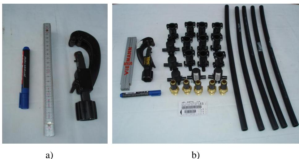
Slika 3.5. Alat i pribor kod rezanje cijevi a) alat i pribor kod rezanja cijevi b) alat, pribor i pripremljeni izrezani uzorci sa spojnim komadima [13]
