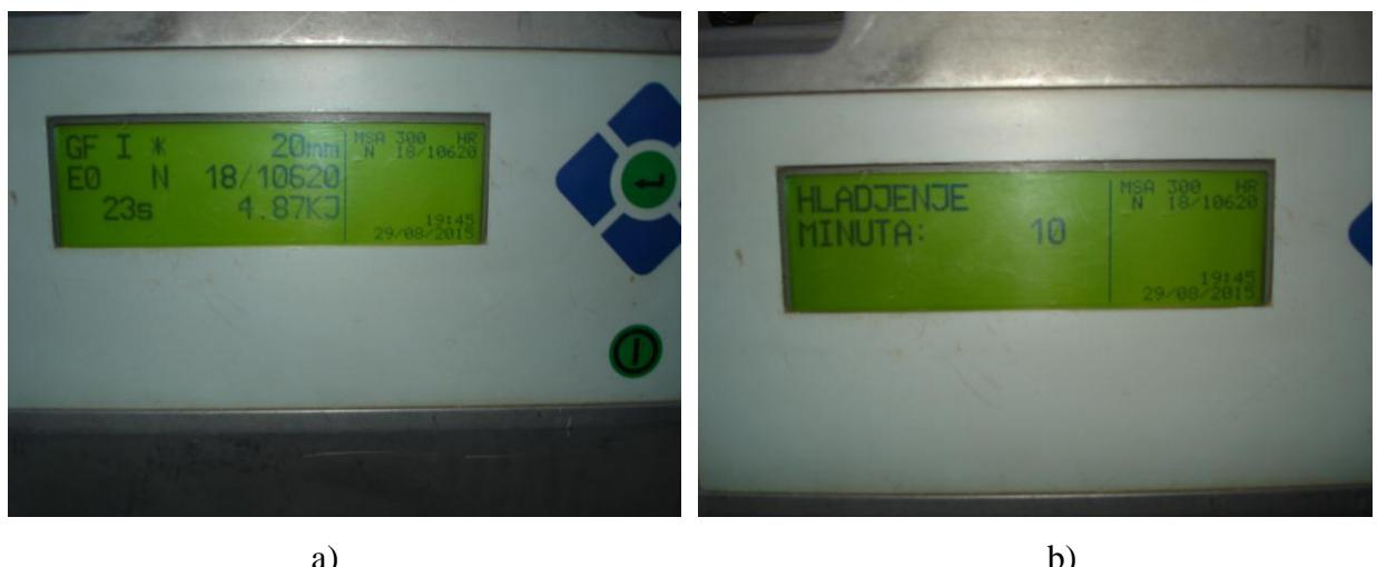
Slika 3.28. Prikaz podataka na zaslonu aparata a) za vrijeme zavarivanja b) za vrijeme postupka hlađenja [13]
