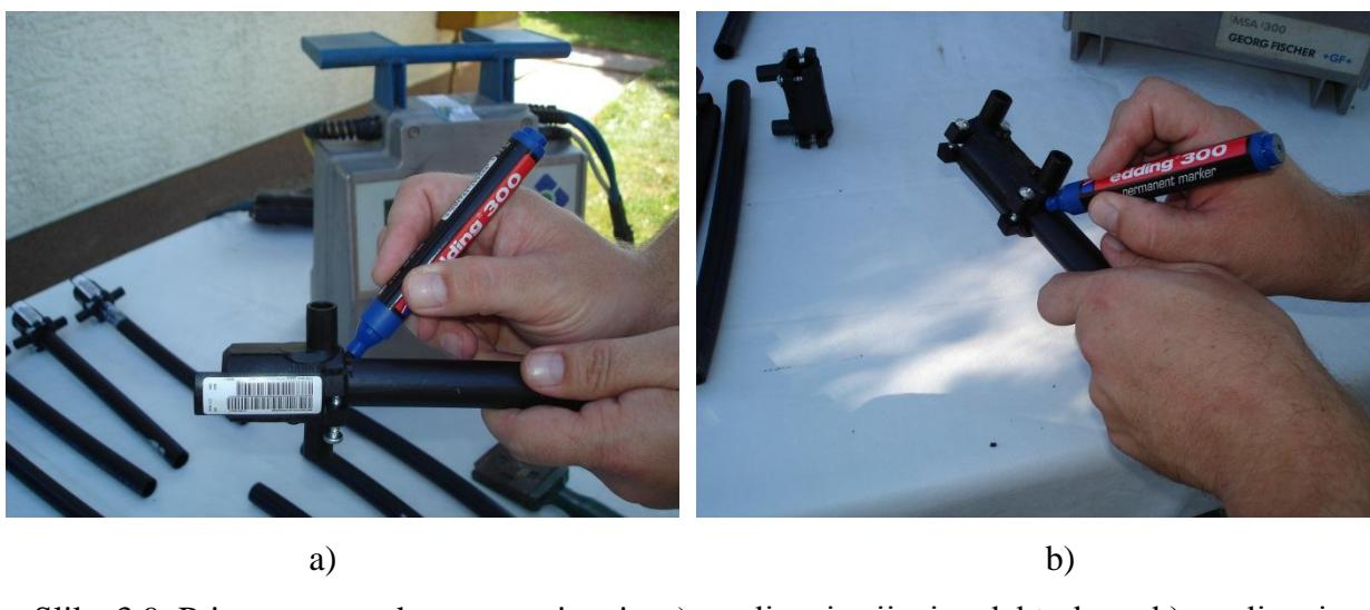
Slika 3.9. Priprema uzoraka za zavarivanje a) usađivanje cijevi u elektrokapu b) usađivanje cijevi u elektrospojnicu i označavanje flomasterom [13]
