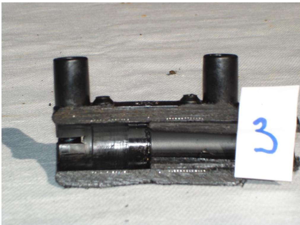
Slika 4.7. Presjek cijevi i elektrospojnice kod uzorka br. 3 [13]
