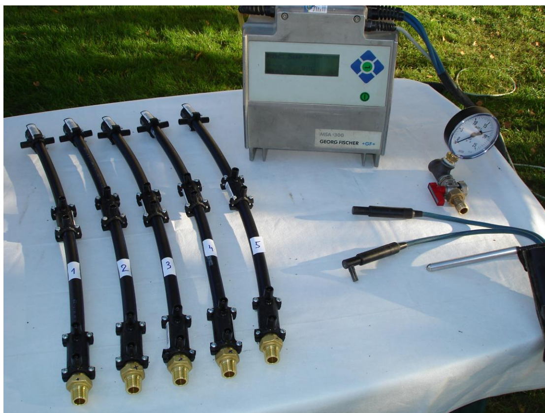
Slika 3.18. Pripremljeni uzorci i oprema za elektrofuzijsko zavarivanje [13]
