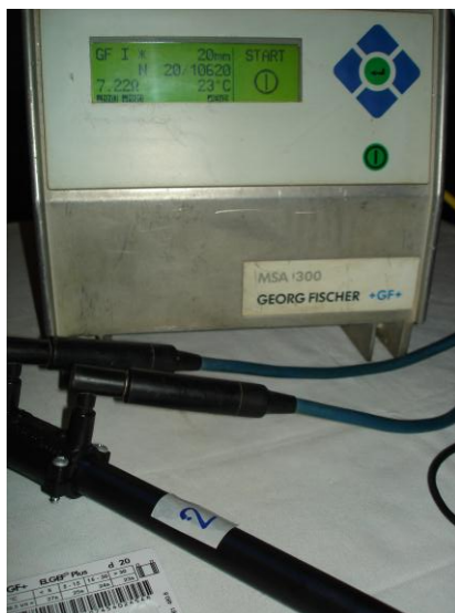
Slika 4.2. Ponovno zavarivanje uzorka br. 2 [13]
