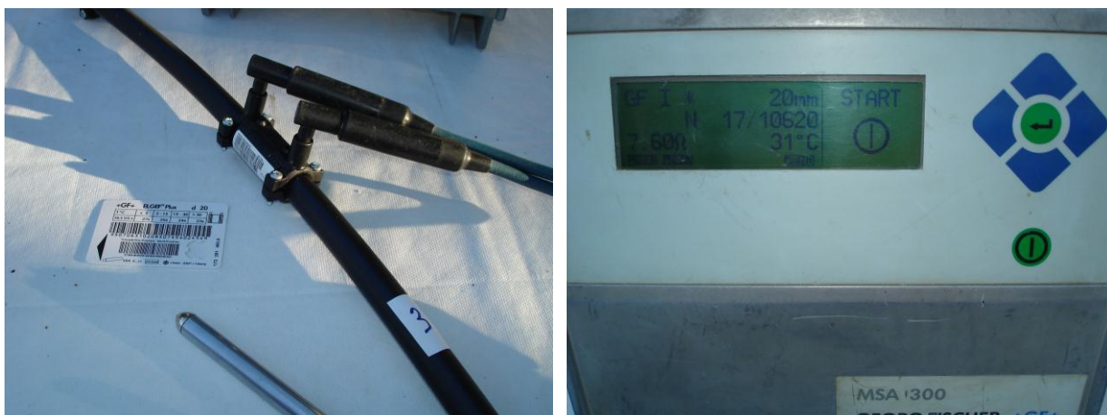
Slika 3.25. Zavarivanje uzorka br. 2 a) spajanje na kablove za zavarivanje b) prikaz podatka na zaslonu aparata očitanih sa magnetske kartice [13]
