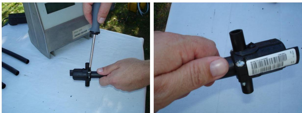
Slika 3.11. Priprema uzorka za zavarivanje a) pričvršćenje elektrokape sa vijcima b)
