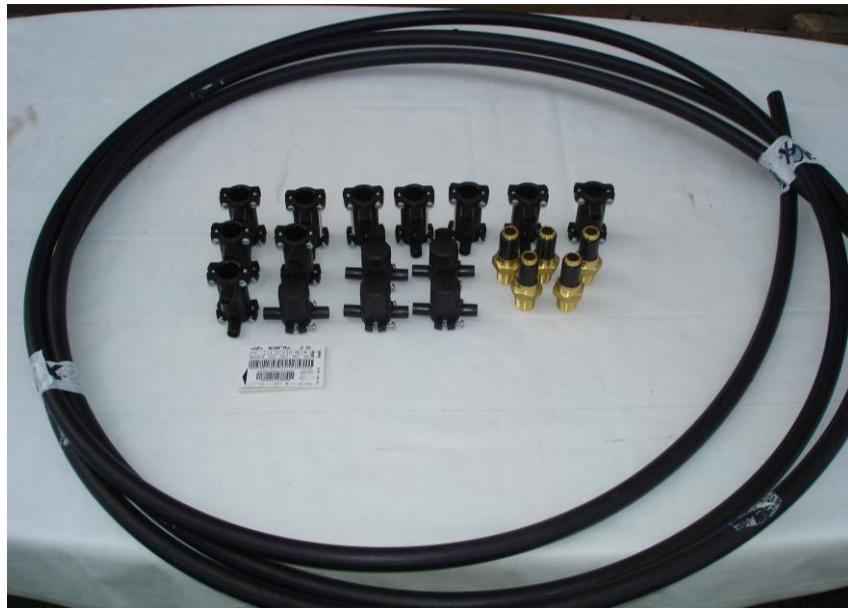
Slika 3.3. Materijal pripremljen za praktični rad, cijevi i elektrofitinzi [13]
