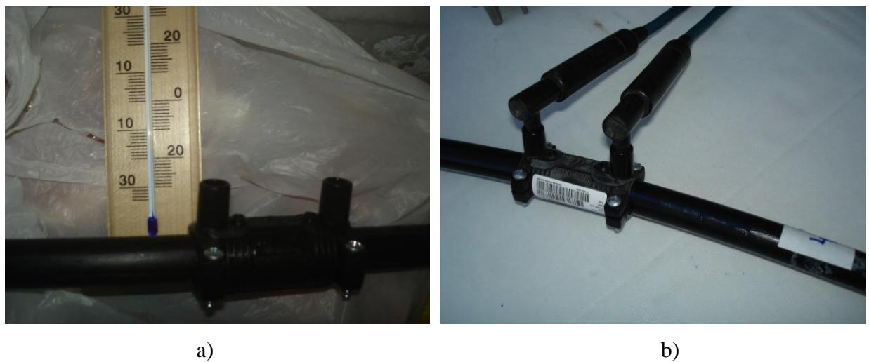
Slika 3.27. Priprema uzorka br. 4 za zavarivanje a) pothlađivanje u ledenici b) spajanje pothlađenog uzorka na kablove za zavarivanje [13]
