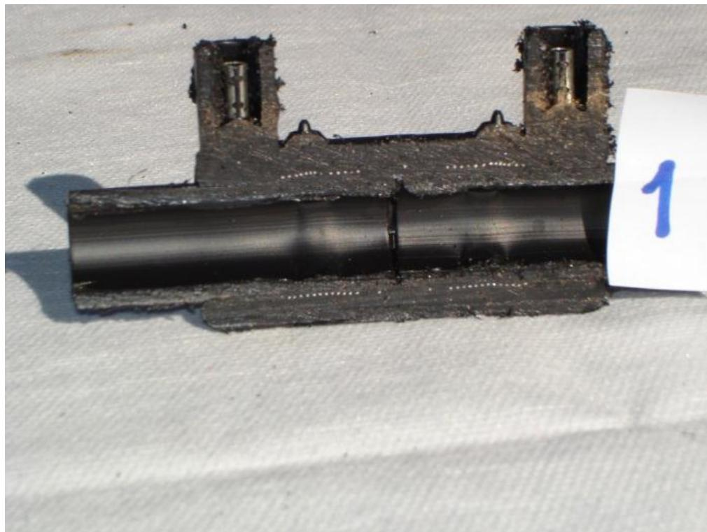
Slika 4.1. Presjek cijevi i elektrospojnice kod uzorka br.1 [13]
