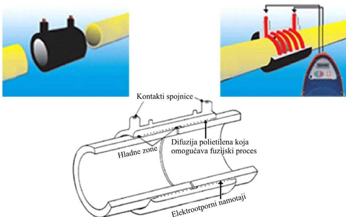
Slika 2.17. Shematski prikaz elektrofuzijskog zavarivanja PE cijevi [11]
