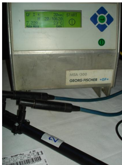
Slika 4.2. Ponovno zavarivanje uzorka br. 2 [13]
