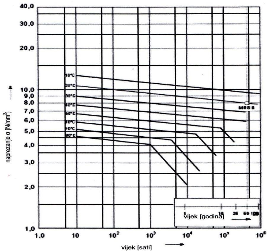
Slika 2.7. Dijagram dugotrajnog naprezanja PE 80 cijevi prema DIN 8075 [4]
