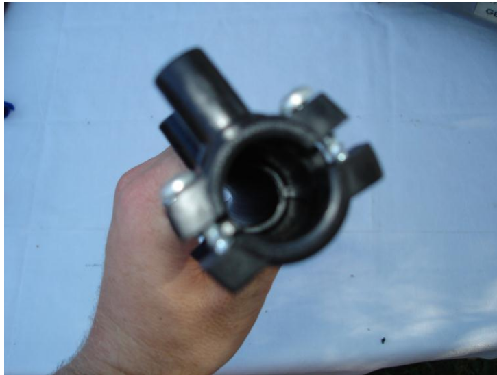
Slika 3.10. Prikaz dosjeda u elektrofitingu nakon umetanja cijevi [13]
