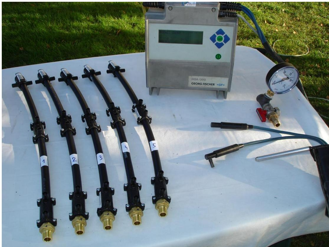
Slika 3.18. Pripremljeni uzorci i oprema za elektrofuzijsko zavarivanje [13]
