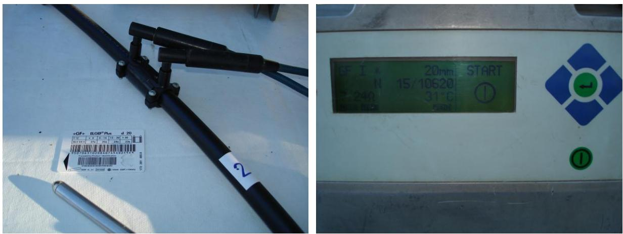
Slika 3.23. Zavarivanje uzorka br. 2 a) spajanje na kablove za zavarivanje b) prikaz podatka na zaslonu aparata očitanih sa magnetske kartice [13]
