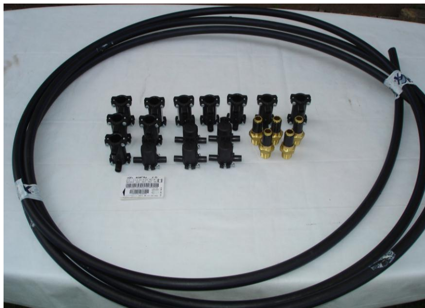
Slika 3.3. Materijal pripremljen za praktični rad, cijevi i elektrofitinzi [13]
