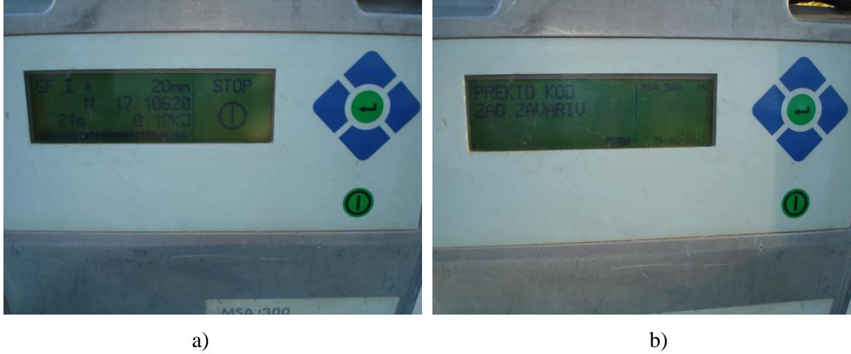
Slika 3.26. Prikaz podataka na zaslonu aparata a) za vrijeme zavarivanja b) nakon ponovnog uključenja [13]
