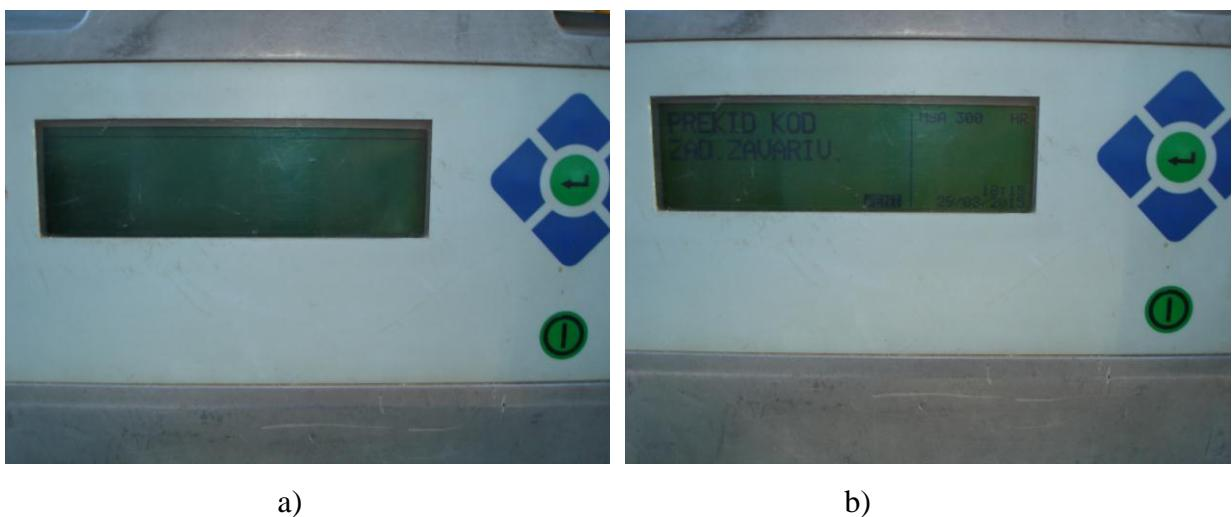
Slika 3.24. Prikaz podataka na zaslonu aparata a) za vrijeme prekida struje b) nakon ponovnog uključenja [13]
