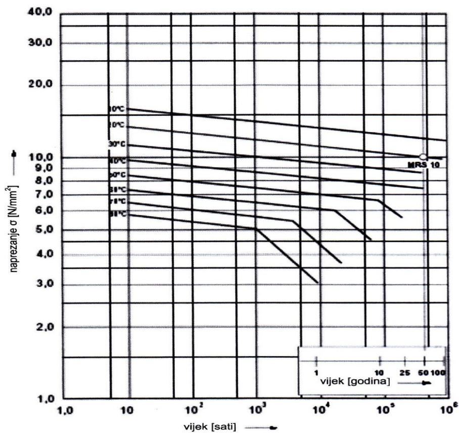
Slika 2.8. Dijagram dugotrajnog naprezanja PE 100 cijevi prema DIN 8075 [4]
