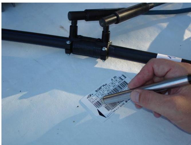
Slika 3.19. Očitavanje barkoda sa magnetske kartice kod zavarivanja prvog uzorka [13]
