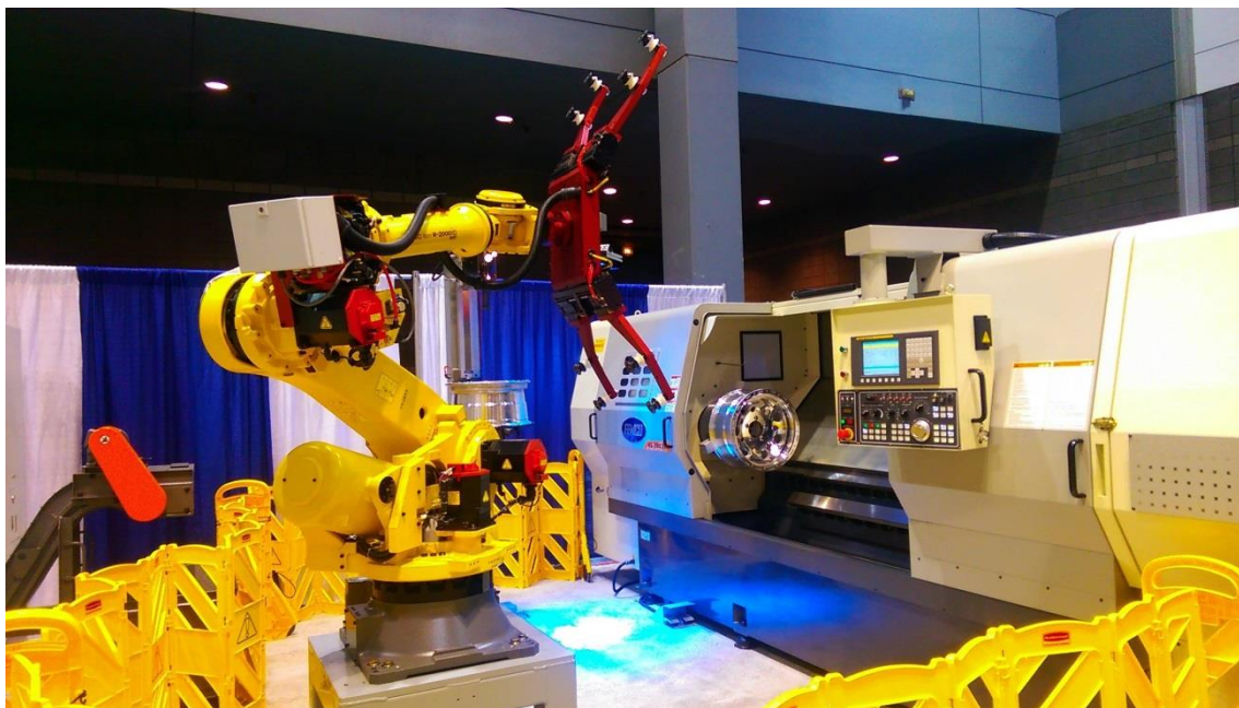
Slika 7.16. Robot posluhuje CNC tokarilicu [14]
