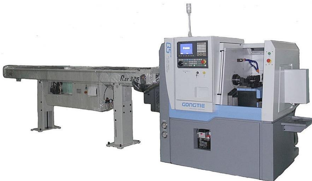
Slika 7.18. Automatsko vođenje šipke kroz glavno vreteno [16]
