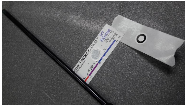
Slika 8.1.11 Mjerenje testex trakicom na poklopcu valovitog kotla.
