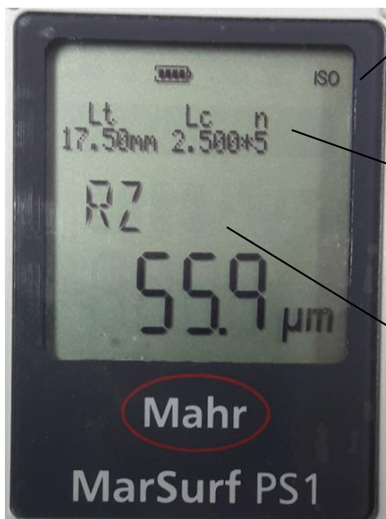
Slika 7.3.1 Prikaz ekrana mjernog uređaja MahrSurf
