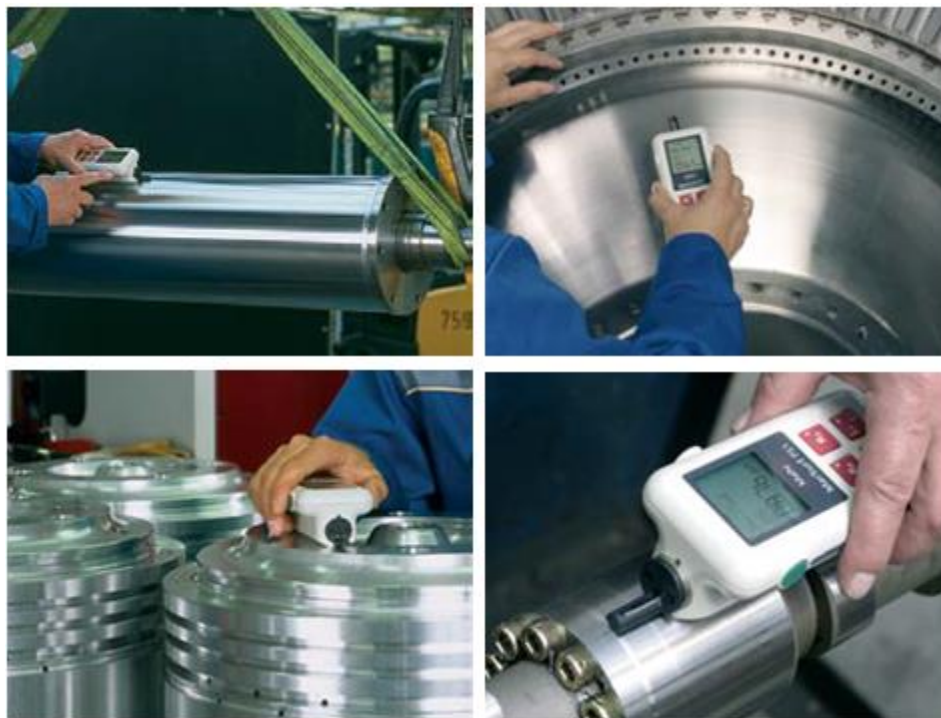
Slika 5.2.1 Prikaz mjerenja pomoću uređaja s ticalom na više načina [10]
