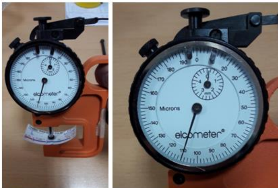
Slika 8.1.12 Prikaz rezultata mjerenjem debljine otiska pomoću mikrometra
