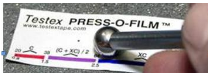
Slika 7.2.4 Utiskivanje pjenastog materijala u površinu koju mjerimo [5]
