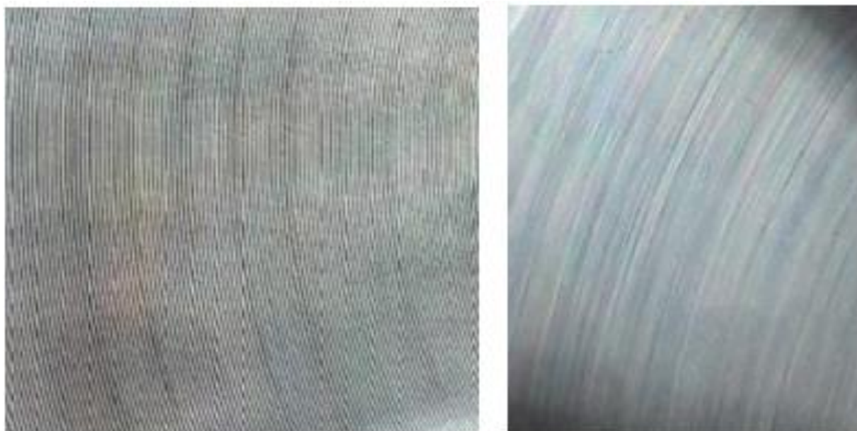
Slika 8.2.5 Prikaz grublje, hrapavije površine i finije površine prirubnice nakon tokarenja
