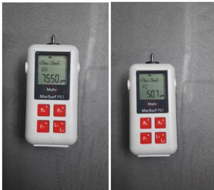
Slika 8.1.13 Prikaz rezultata mjerenja hrapavosti poklopca mjernim uređajem
