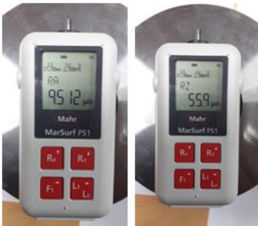
Slika 8.2.4 Rezultati mjerenja hrapavosti – hrapavost izvan dopuštenih granica
