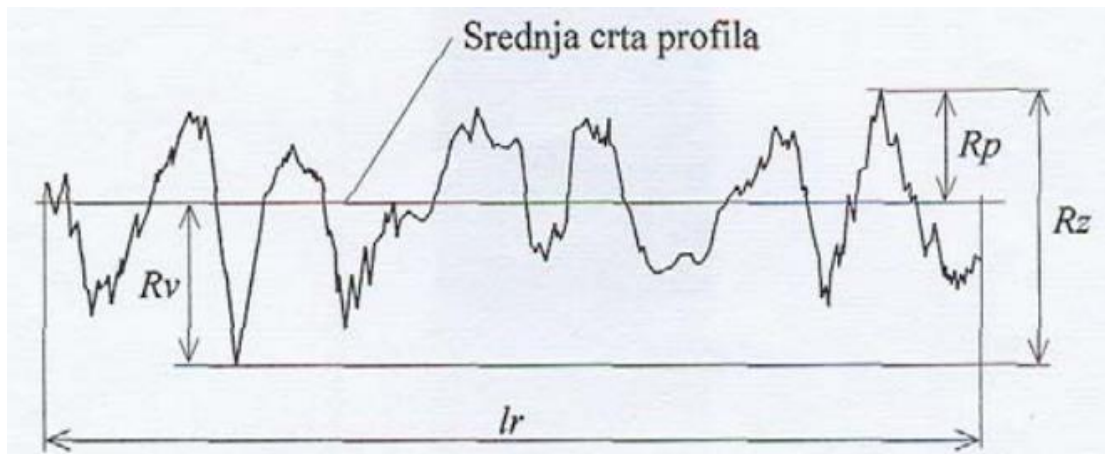
Slika 4.2.2 Prikaz odnosa R_z , R_p i R_v [6]
