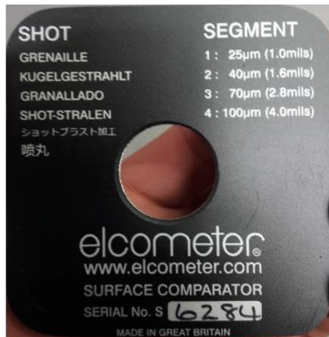
Slika 8.1.10 Vrijednosti hrapavosti za Shot (okruglu sačmu)
