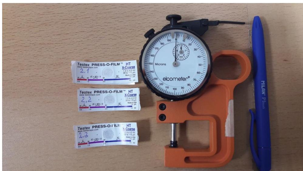
Slika 8.1.17 Tri otisnuta uzorka hrapavosti i mjerenje mikrometrom
