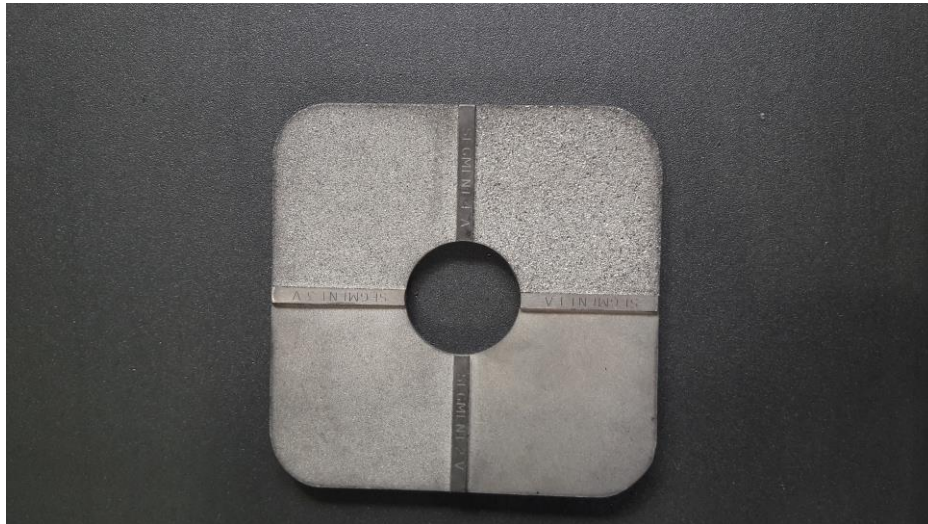
Slika 8.1.2 Usporedna pločica - komparator
