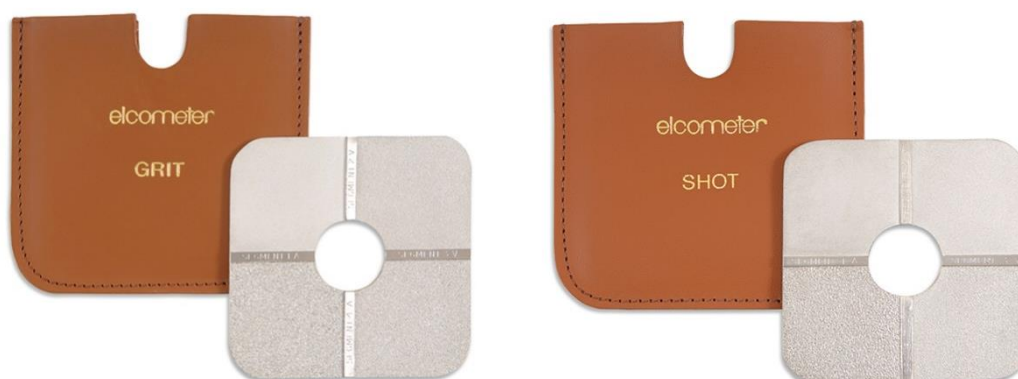
Slika 7.1.1 Komparatori: lijevo "Grit" komparator, desno "Shot" komparator [5]
