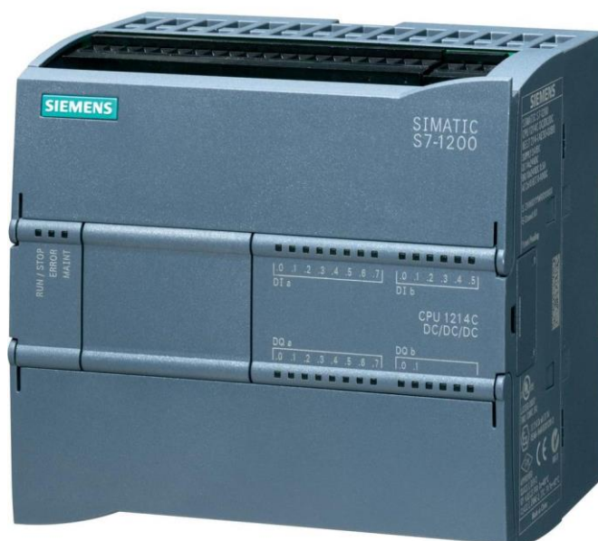
Slika 3.1 Siemens CPU serije S7-1200, model 1214C [4]
