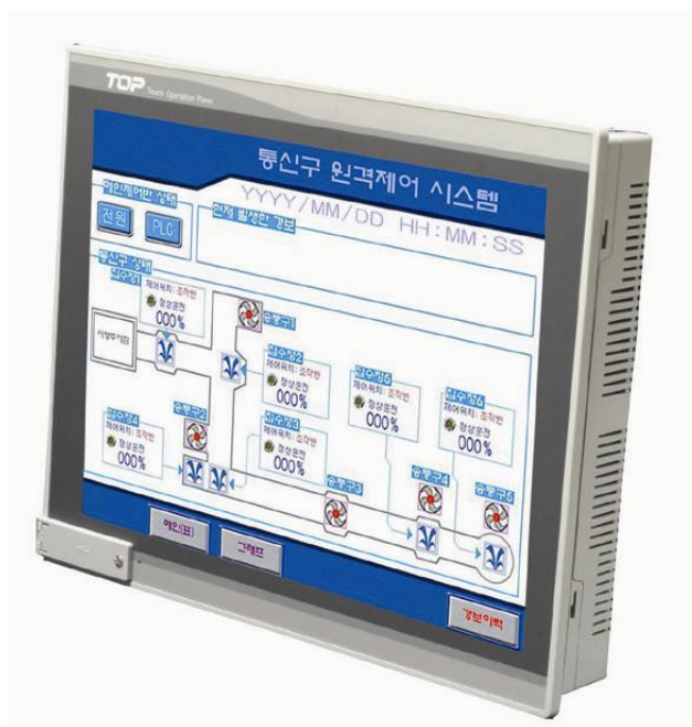
Slika 3.2 HMI – Čovjek-stroj sučelje
