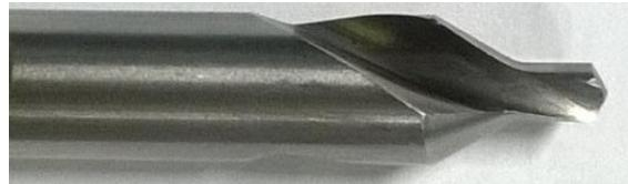
*Slika 6.17 Zabušivač Ø8 mm*
