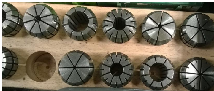
Slika 6.8 Univerzalne elastične čahure raznih promjera
