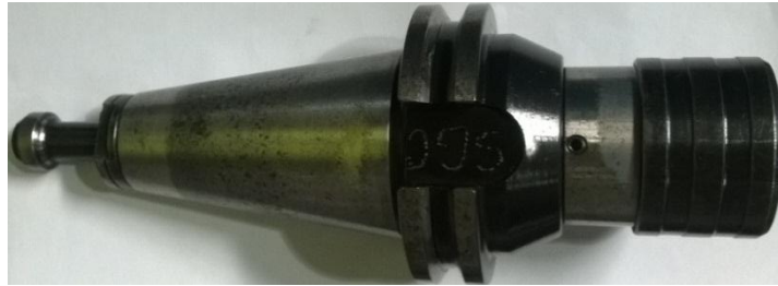
Slika 6.10 Glava za urezivanje navoja
