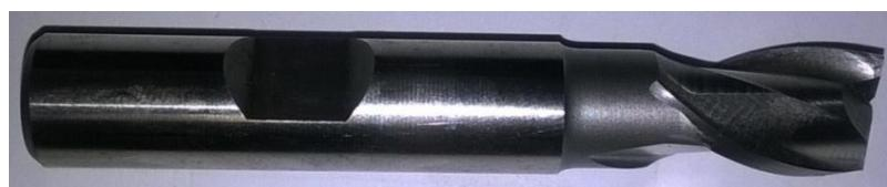
Slika 6.16 Glodalo dvorezno Ø10 mm
