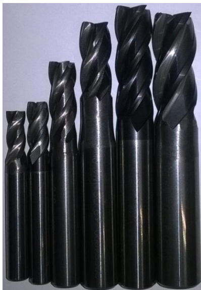
Slika 6.15 Set višereznih glodala
