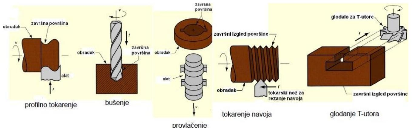
Slika 4.3 Izgled obratka ovisi o geometriji alata [2]
