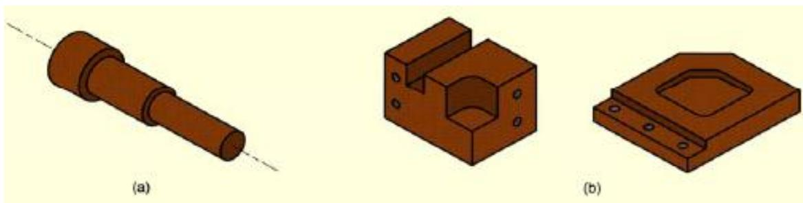
Slika 4.1 Rotacijsko simetrični (a) i nesimetrični dijelovi (b) [2]
