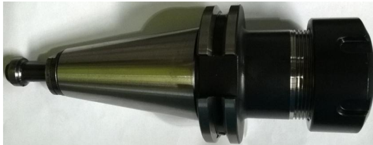
Slika 6.7 Držač elastične čahure
