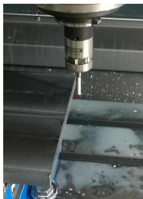
*Slika 8.7 Mjerenje nul-točke*
