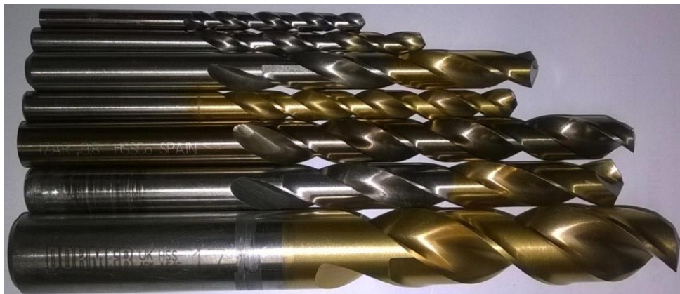
Slika 6.12 Set spiralnih svrdla
