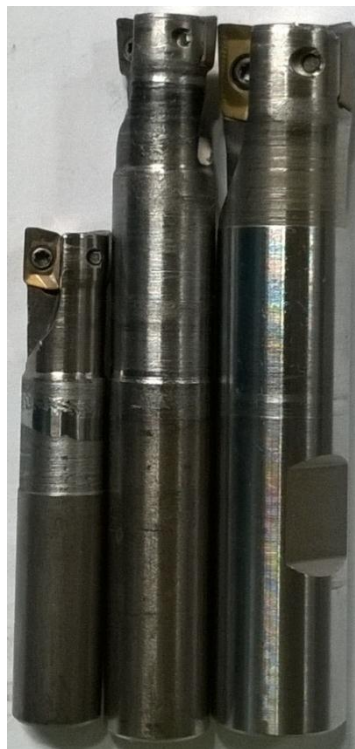
Slika 6.18 Glodala sa pločicama Ø10 mm, Ø12 mm i Ø16 mm
