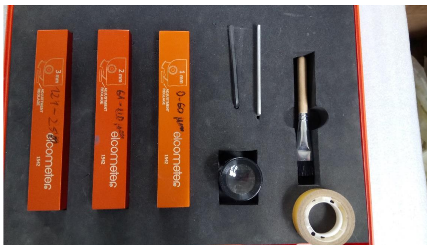
Slika 31. Oprema potrebna za izvođenje cross-cut testa
