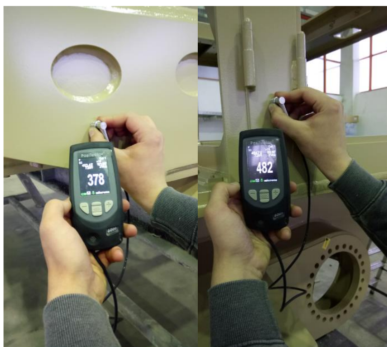
Slika 29. Mjerenje debljine suhog filma završnog premaza na šasiji MV-10
