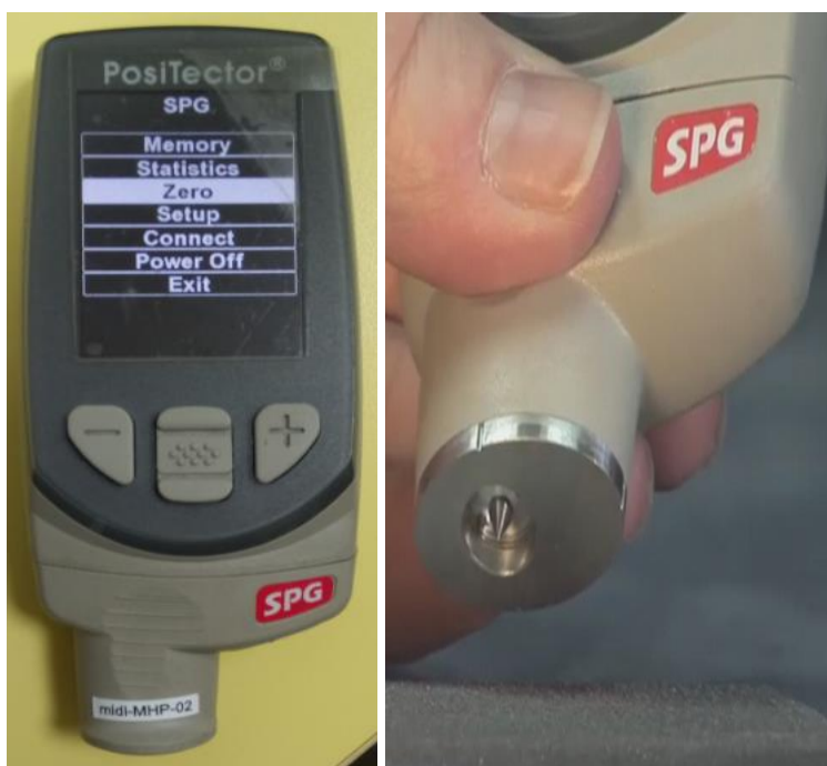
Slika 16. Uređaj za mjerenje hrapavosti PosiTector SPG
