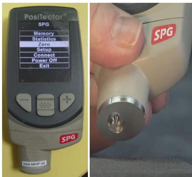
Slika 16. Uređaj za mjerenje hrapavosti PosiTector SPG
