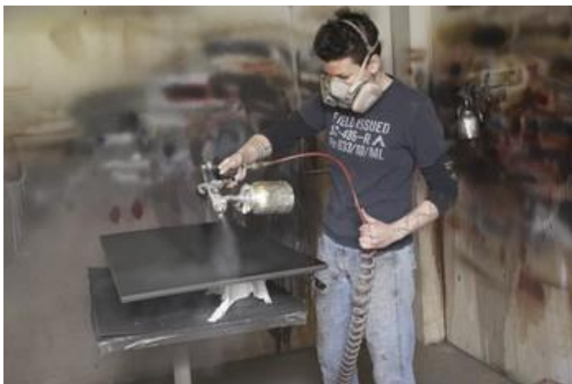
Slika 6. Nanošenje premaza zračnim štrcanjem [8]
