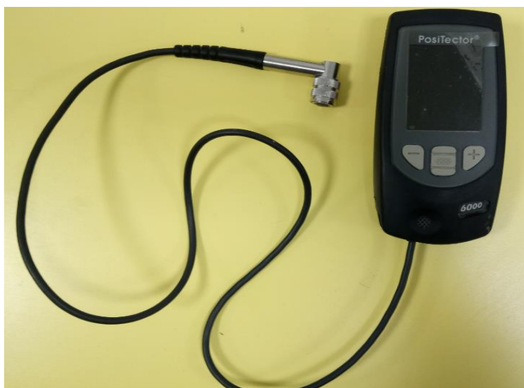
Slika 28. Uređaj za mjerenje debljine suhog filma premaza PosiTector 6000
