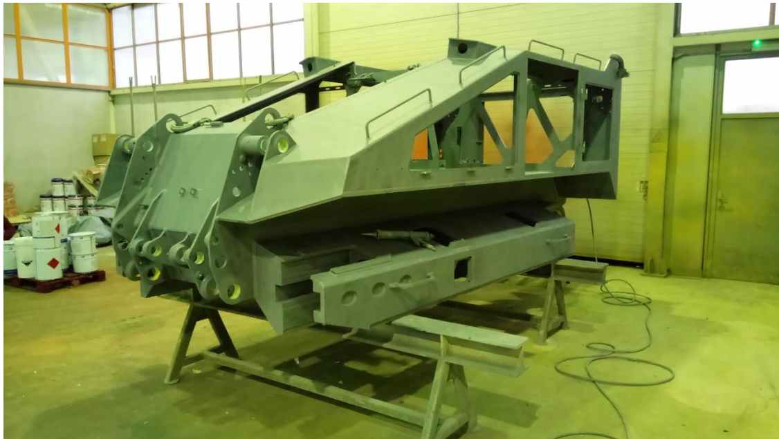
Slika 12. Šasija stroja za razminiranje MV-10 nakon pjeskarenja
