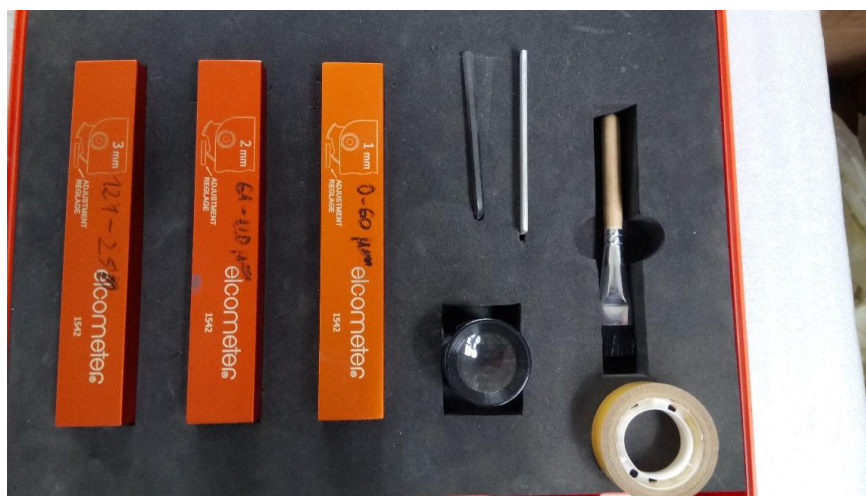
Slika 31. Oprema potrebna za izvođenje cross-cut testa
