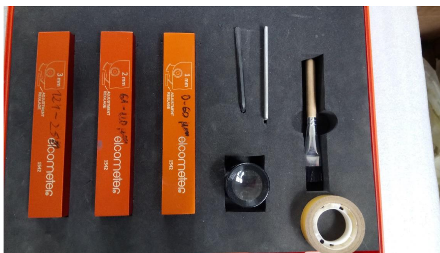
Slika 31. Oprema potrebna za izvođenje cross-cut testa
