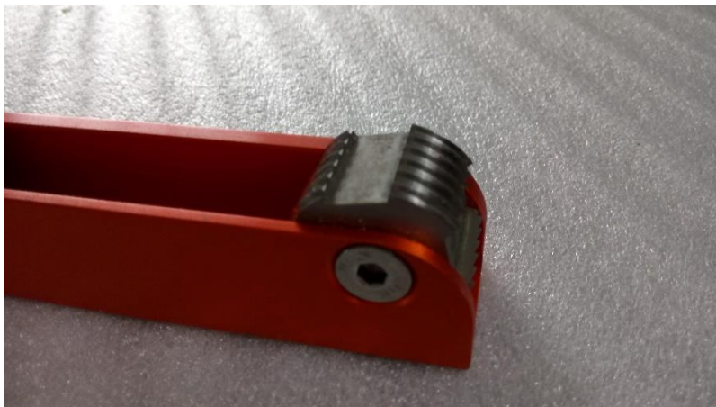
Slika 32. Uređaj sa noževima za debljinu premaza od 121 - 250 \mu\text{m}
