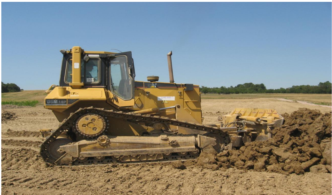
Slika 9. Buldožer za guranje iskopanog tla na manje udaljenosti
