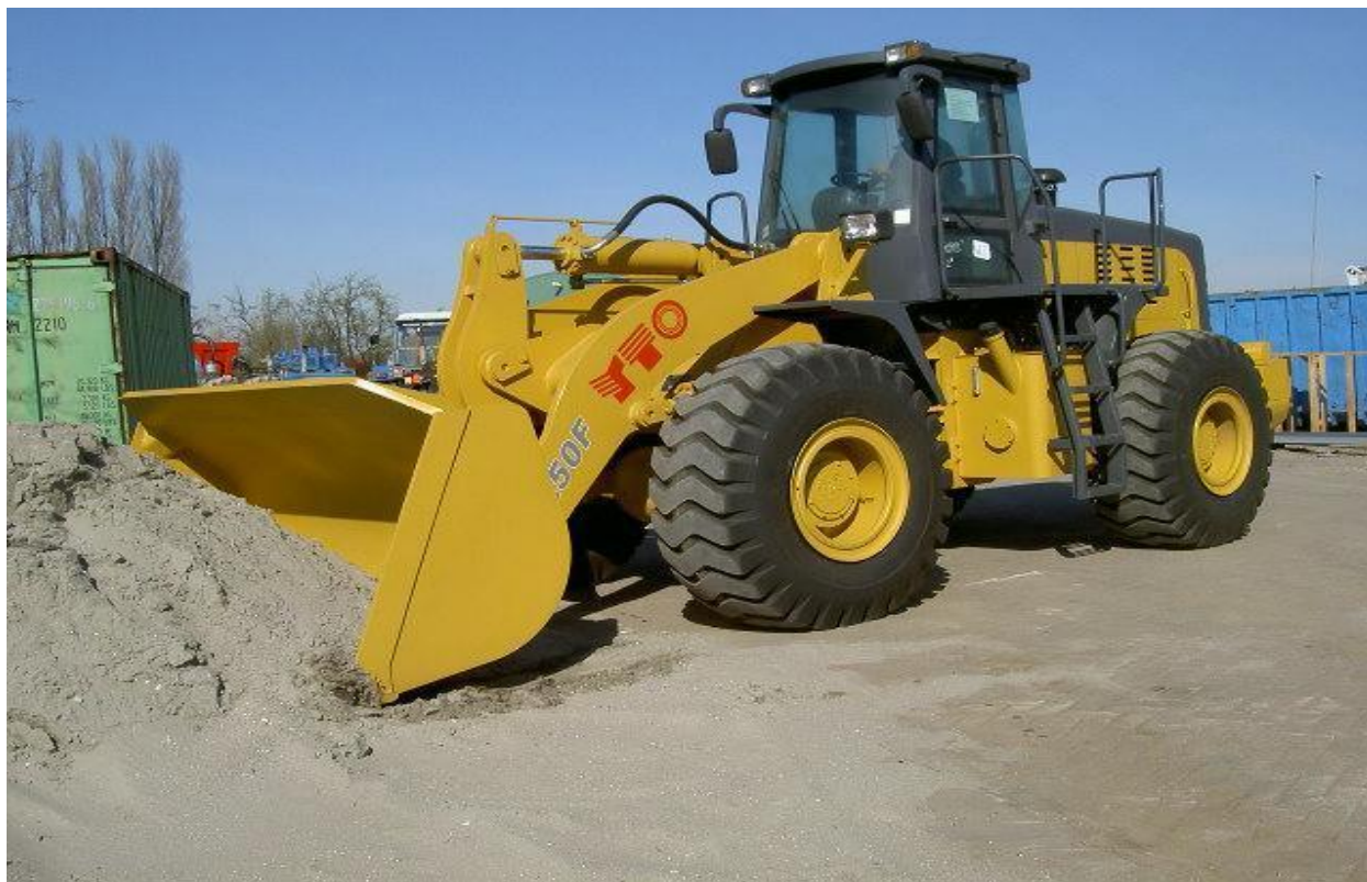
Slika 12. Utovarivač za utovar iskopanog materijala
