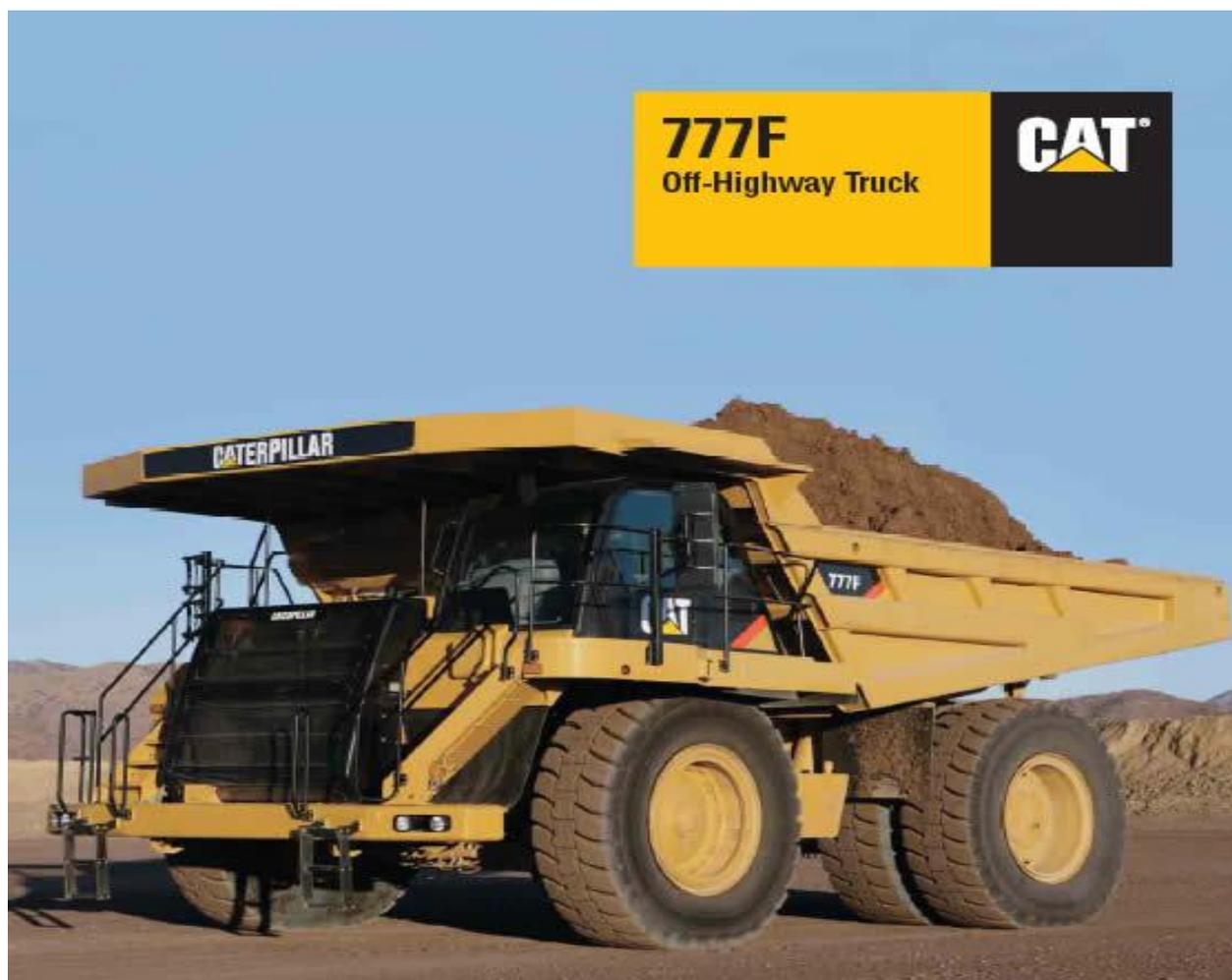
*Slika 11. Damper za prijevoz sipkih materijala namijenjen gradilišnom prijevozu*
