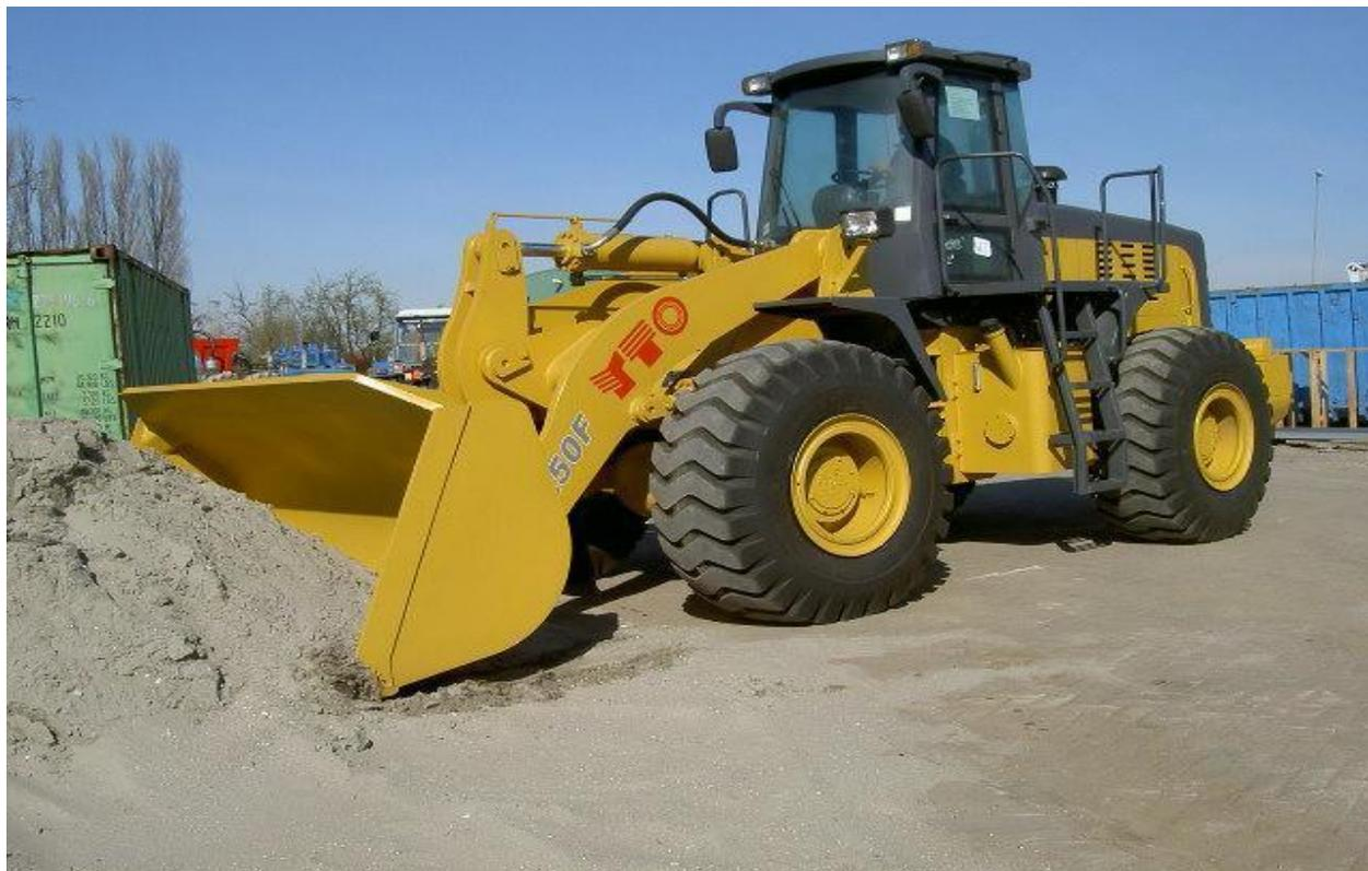
*Slika 12. Utovarivač za utovar iskopanog materijala*
