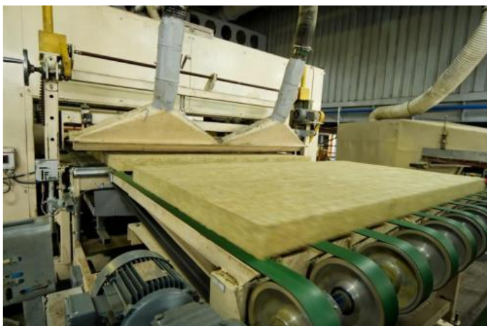
Slika 9. Rezanje vune na željene dimenzije
