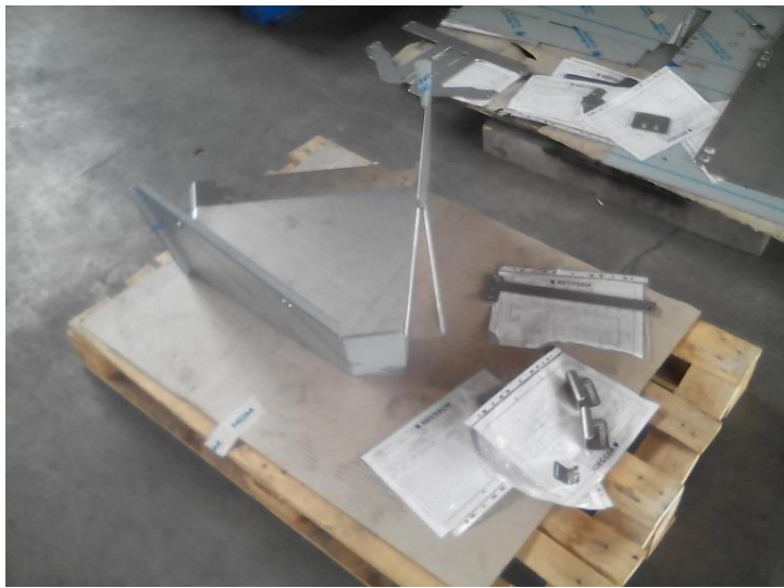
Slika 4.5. a) Pozicija dobivena na savijačici
