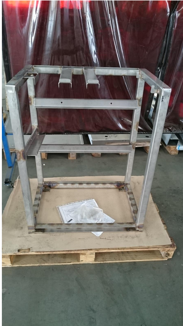
Slika 4.36. Kolica nakon zavarivanja (druga strana)
