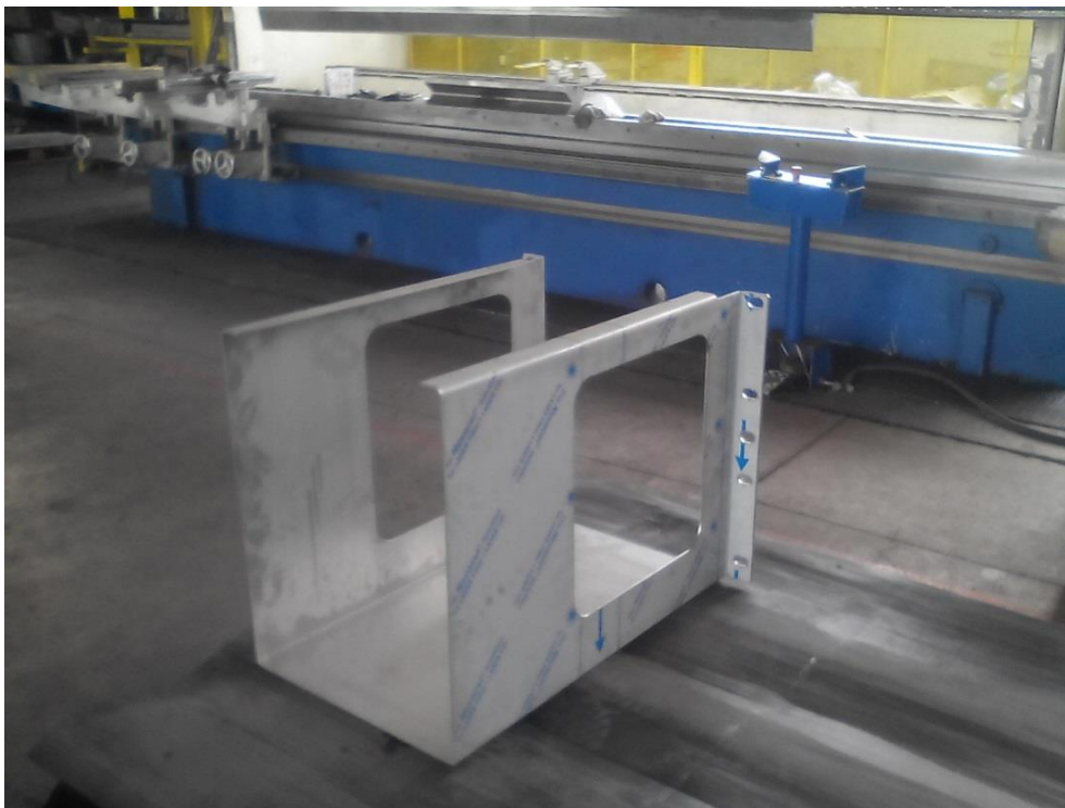
Slika 4.4. Pozicija dobivena na savijačici
