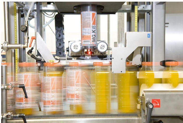
Slika 30. Stroj za sleeveiranje
