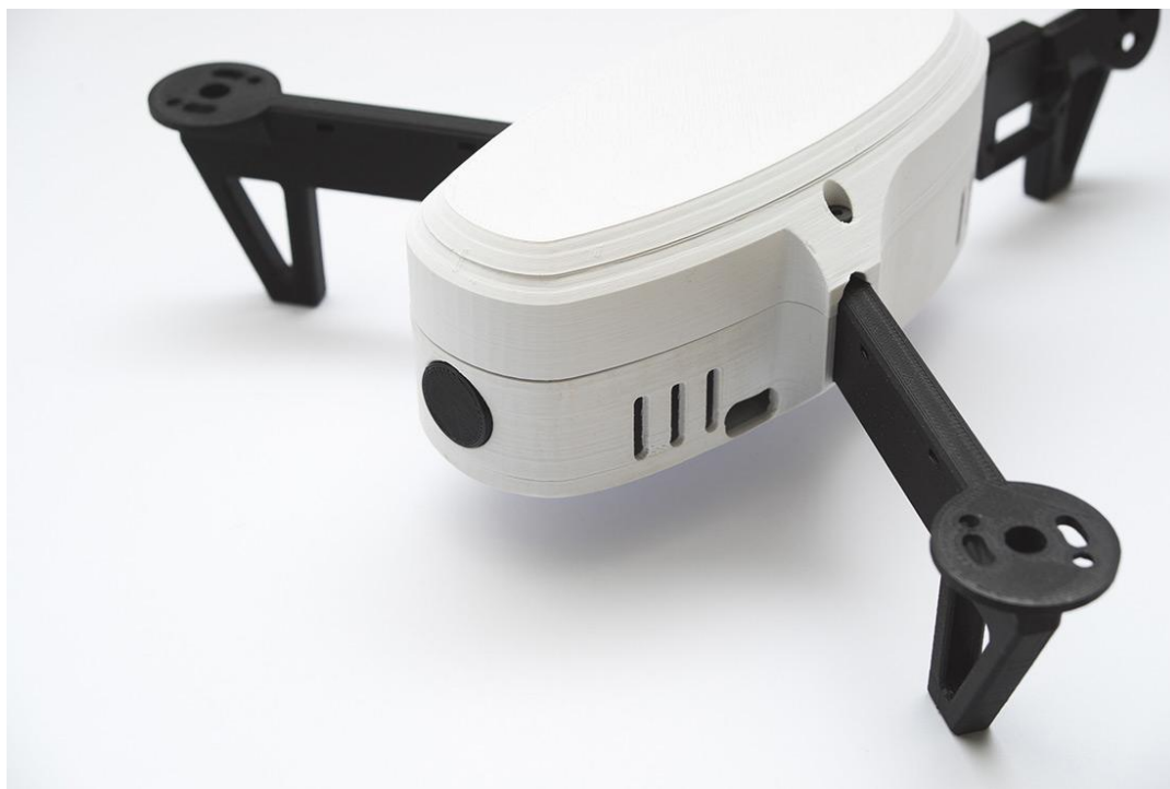
Slika 2.4 Dron izrađen FDM tehnologijom ispisa [2]
