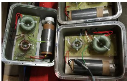
Slika 50 Otvorena kutija sa prikazom rendgen. cijevi (autor)
