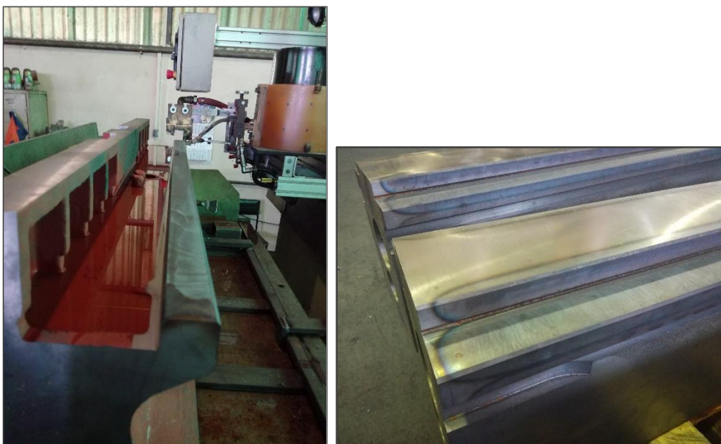
Slika 10.1: Indukcijsko kaljenje vodilica stroja (lijevo), izgled kaljene površine (desno)
