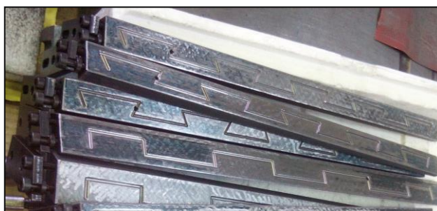
Slika 7.22: Kombinacija dva tipa vodilica suporta CNC glodalice (lijevo), Slika 7.23: Kompenzacijske klinaste letve za podešavanje zračnosti između vodilica AS (desno)
