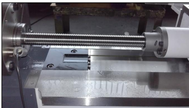
Slika 7.11: Kuglično navojno vreteno „Z“ osi
