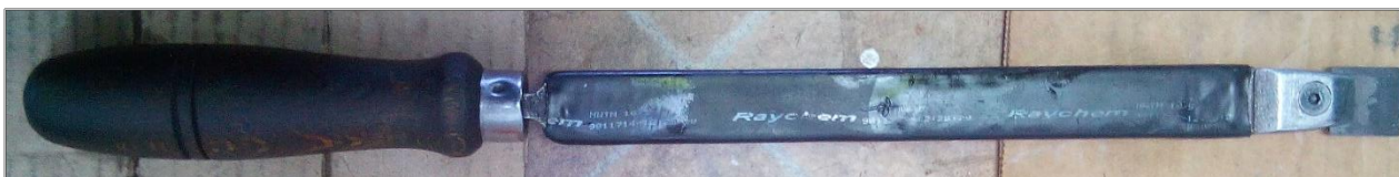
Slika 8.3: Grečalo sa oštricom od tvrdog metala
