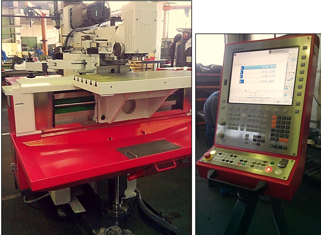
Slika 11.7: CNC glodalica sa upravljačkom jedinicom stroja
