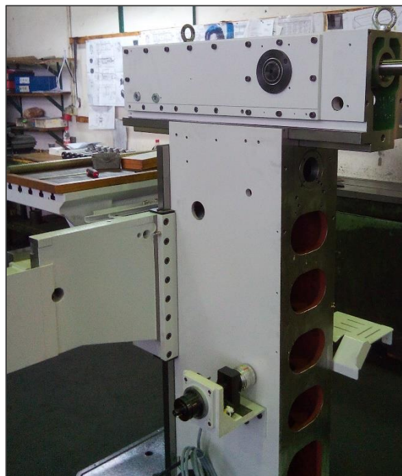
Slika 11.3: Stroj sa postavljenim vreteništem, radnim stolom i križnim suportom
