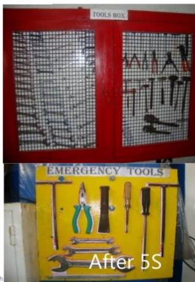
Slika 2.8. Spremište alata prije i poslije 5S implementacije [8]
