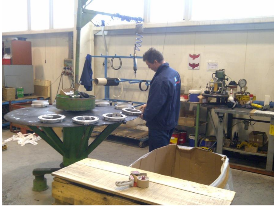
Slika 3.3. Montaža leptirastog ventila na rotacionom stolu [28]
