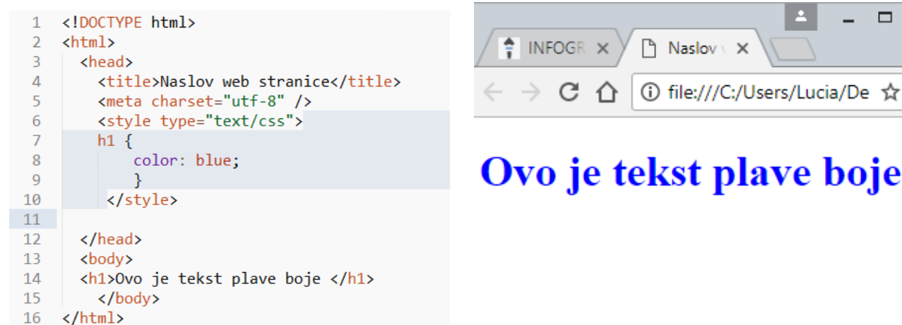
Slika 4.7 Primjer internog CSS-a u zaglavlju (desno kôd, lijevo prikaz u Internet pregledniku)
