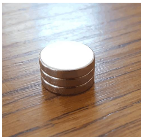
Slika 7.2. Neodimijski magneti predviđeni za utore na prototipu rotora
