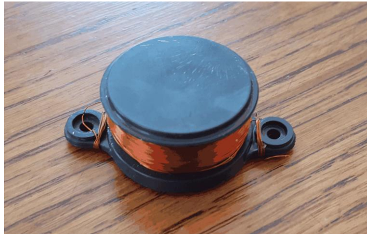
Slika 7.3. Metalna zavojnica s 2000 namotaja predviđena za spajanje na prototip postolja
