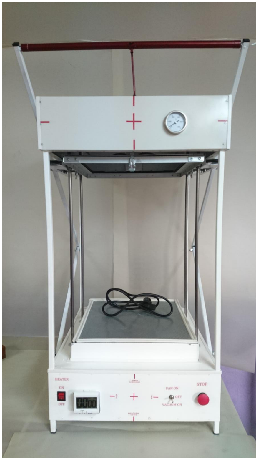
Slika 3.117 Kompletiran uređaj za toplo oblikovanje polimera sa naljepnicama i oznakama
