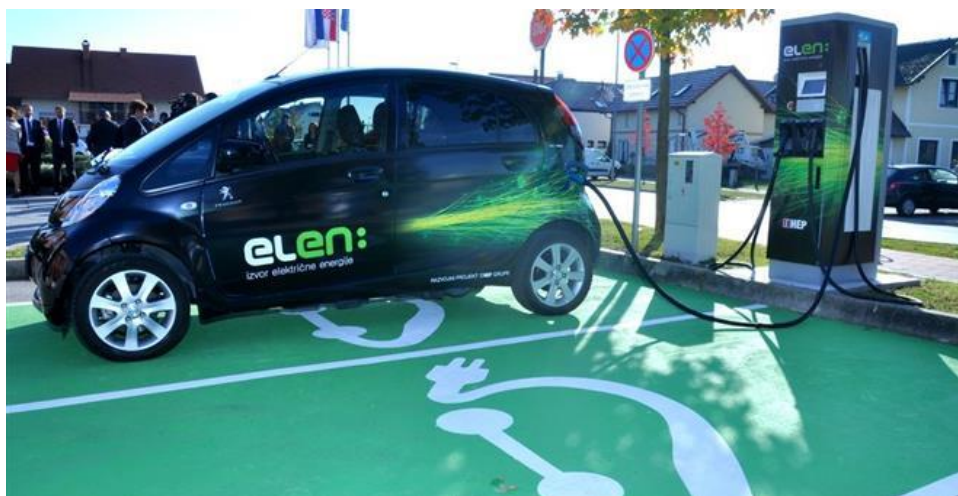
Slika 2.6. Prikaz konduktivnog punjenja EV [2]
