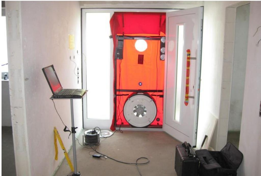
*Slika 4.5.1. Ispitivanje blower door testom*
