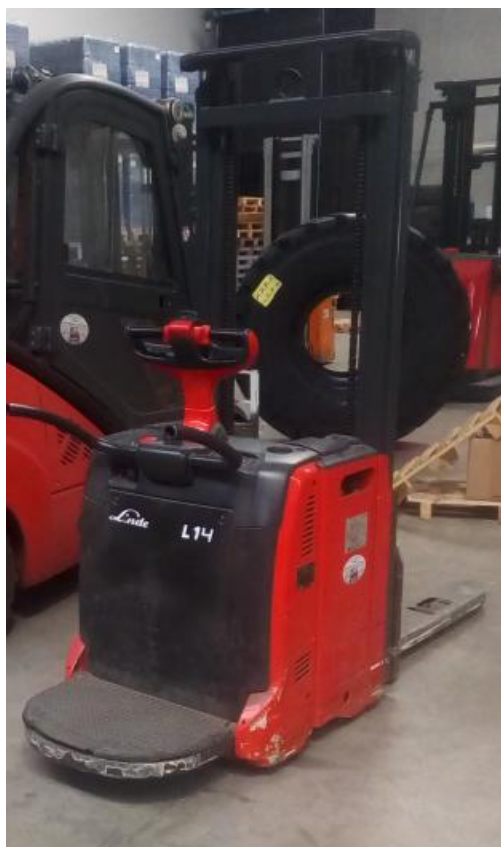
Slika 4.10. : Ručni električni viličar Linde L14 AP
