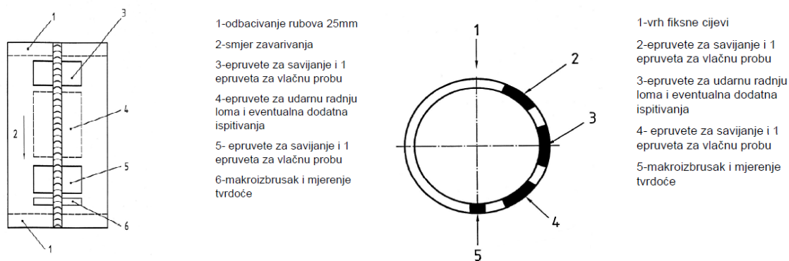
Slika 10. Izgled ispitnih uzoraka za sučeonu i sučeonu spoj cijevi [17]
