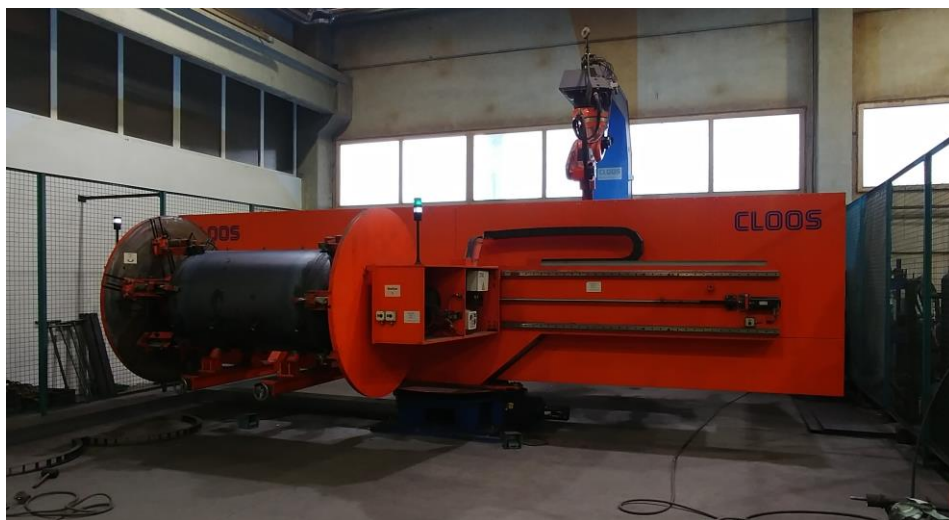
Slika 6. Robot za zavarivanje akumulacijskih spremnika
