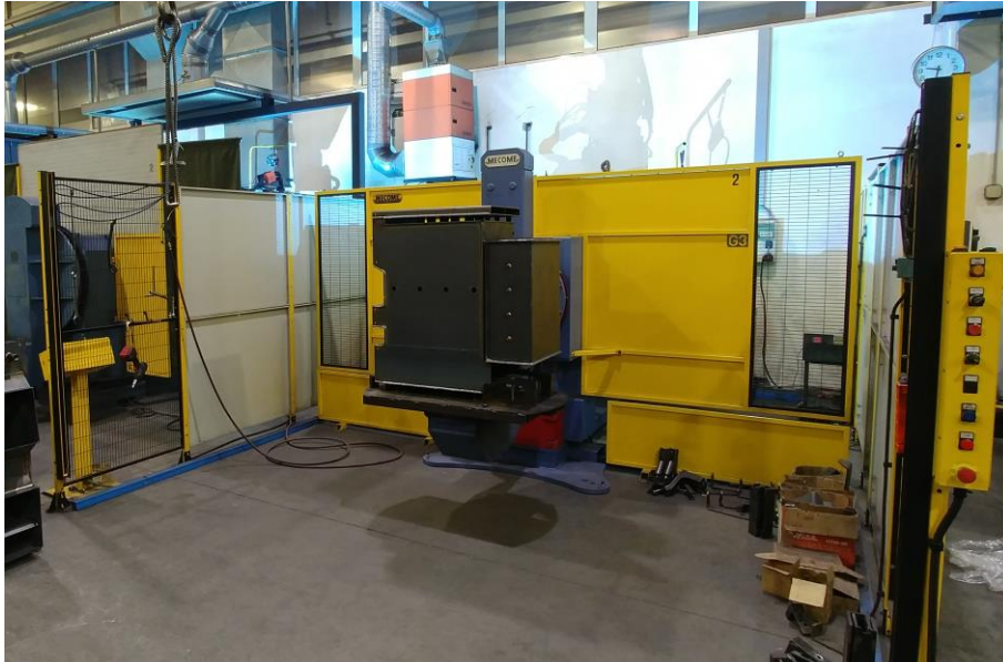
Slika 3. Robot za zavarivanje s okretnim stolom i pozicionerom
