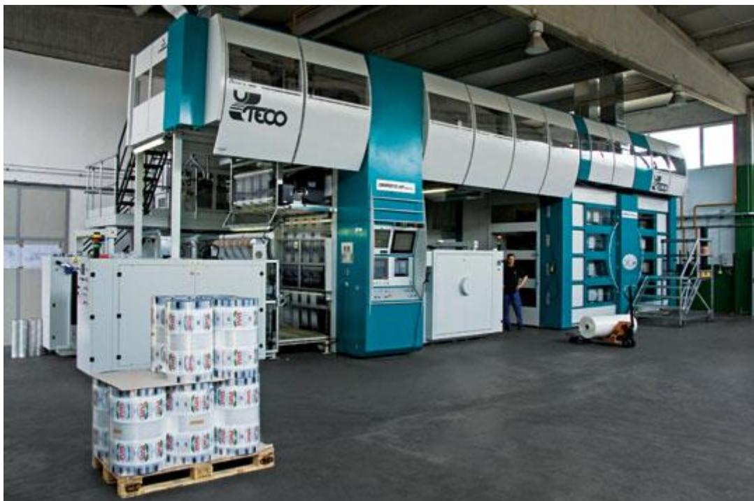
*Slika 2.19 Osmerobojni fleksografski stroj s centralnim cilindrom*
