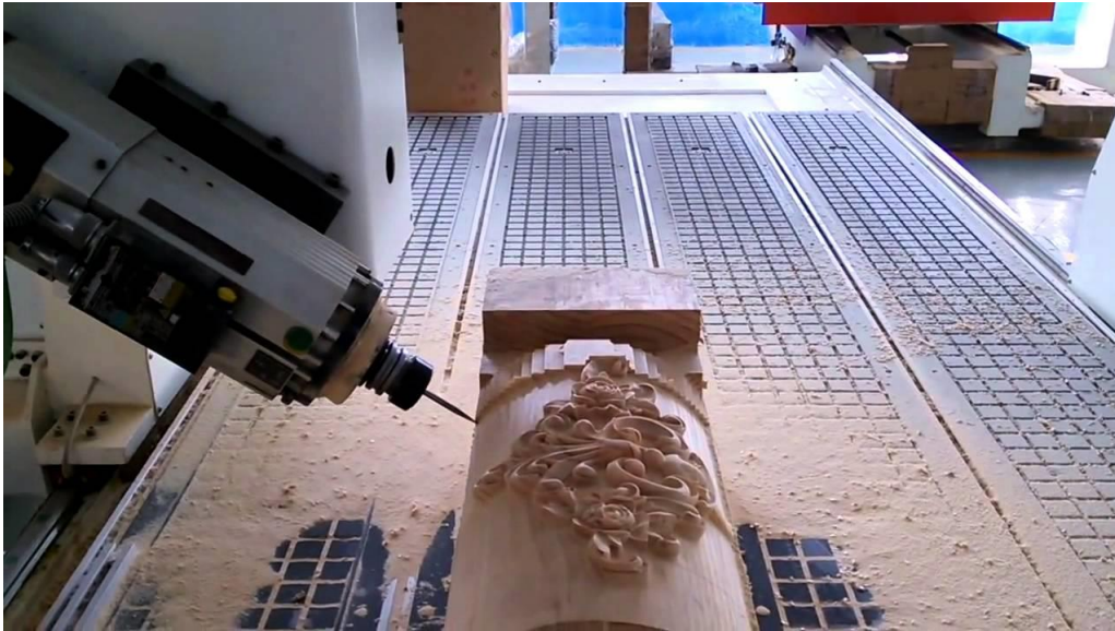
Slika 14. Petoosna obrada u drvenoj industriji [8]
