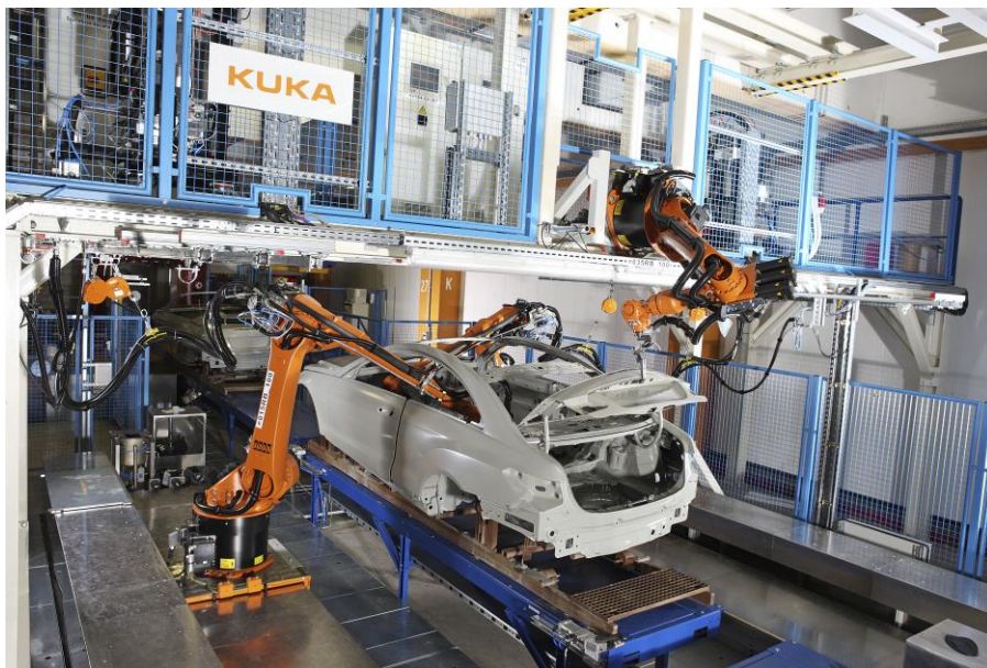
Slika 5. FMS sustav u automobilske industriji [3]
