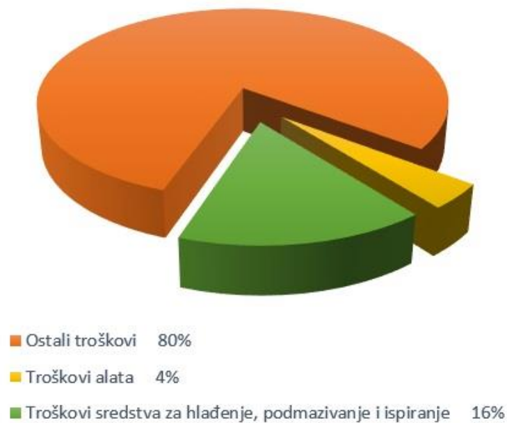
Slika 20. Prikaz omjera troškova kod zbrinjavanja sredstva za hlađenje, podmazivanje i ispiranje
