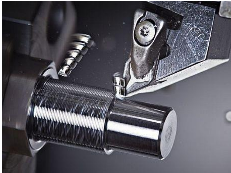
Slika 19. Tokarenje otvrdnutog materijala [10]
