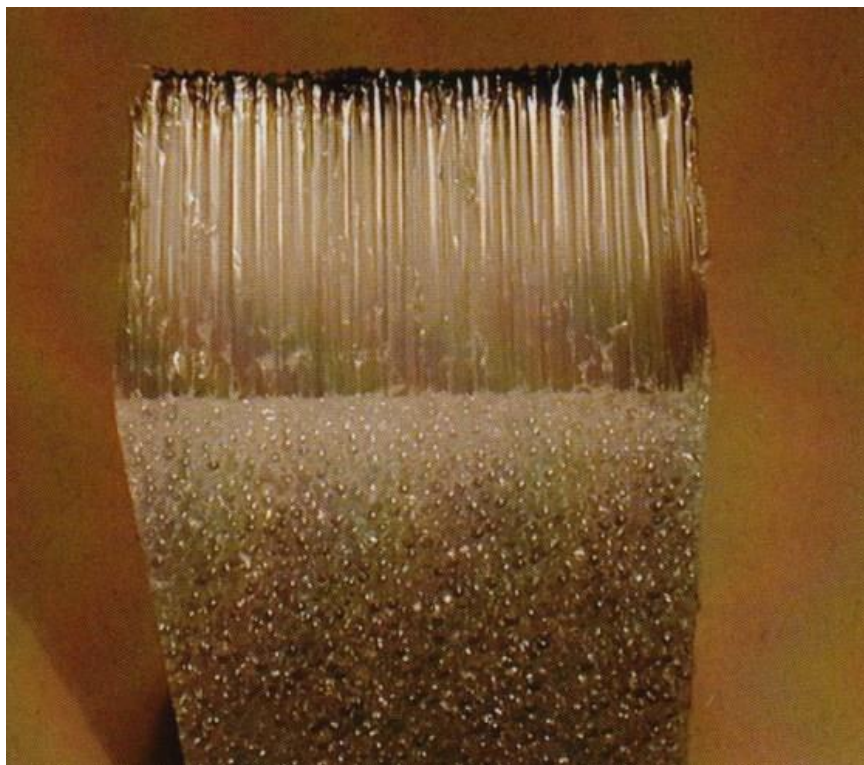
Slika 14. Prozirna toplinska izolacija
