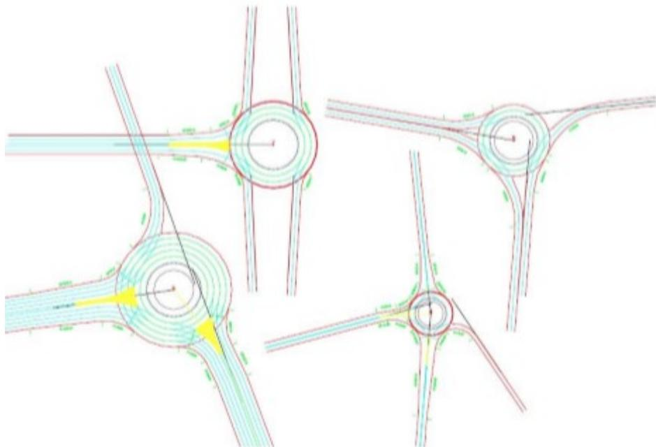
Slika 10.27 Više tipova priključenja na kružni tok
