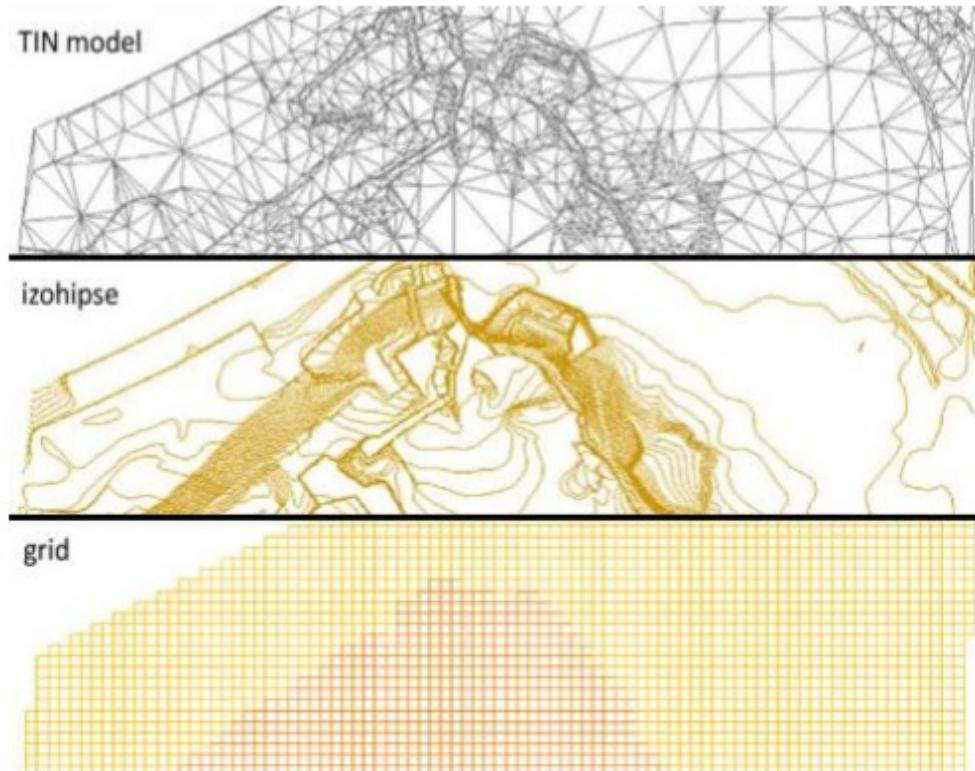
Slika 10.3 Digitalni model terena u tri vrste prikaza
