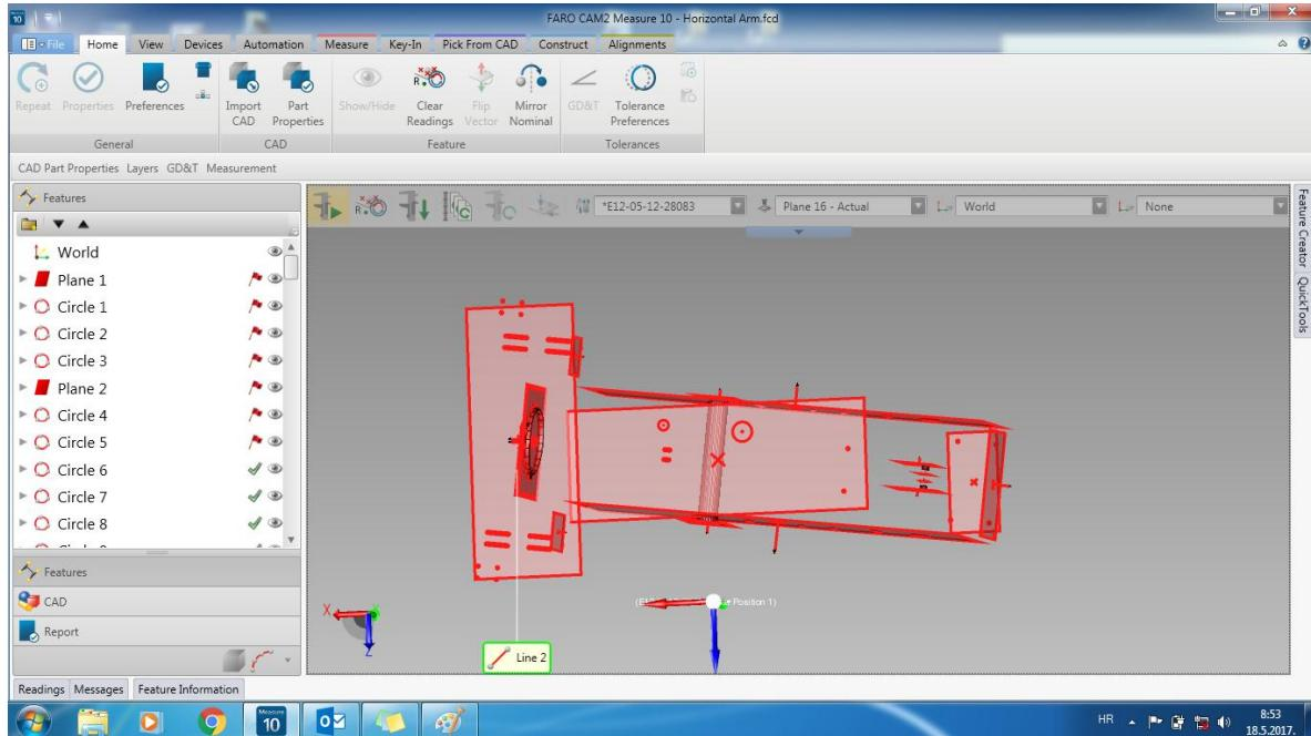
Slika 56. Nacrtan dio pogona u programu CAM2 Measure na temelju površina koje smo izmjerili
