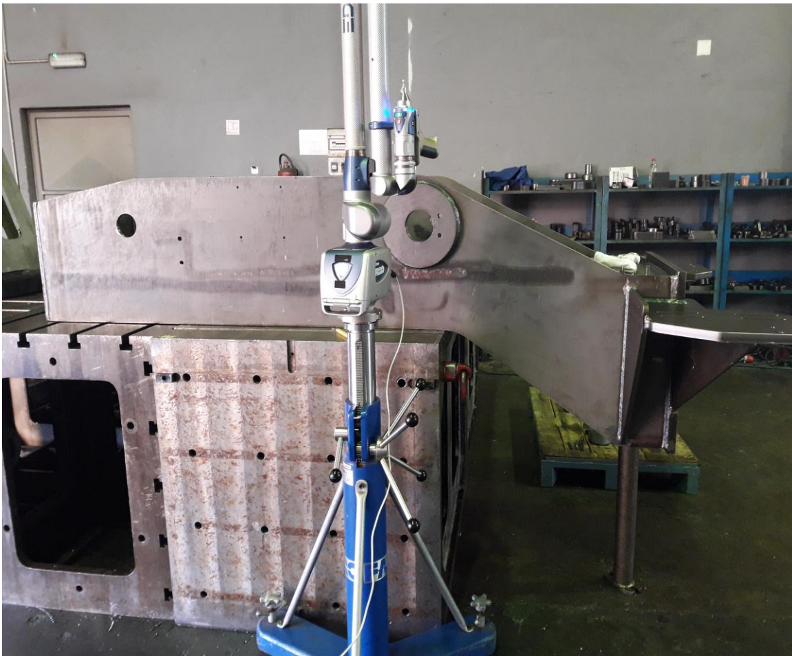
Slika 36. Postavljanje Faro ruke u odnosu na komad mjerenja
