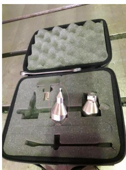
Slika 43. Ticalo (promjer kugle 6 mm) pomoću kojeg mjerimo
