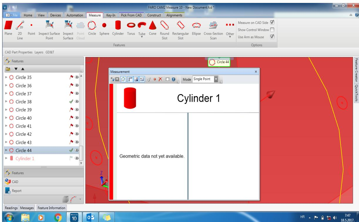
Slika 53. Mjerenje cilindra u programu CAM2 Measure
