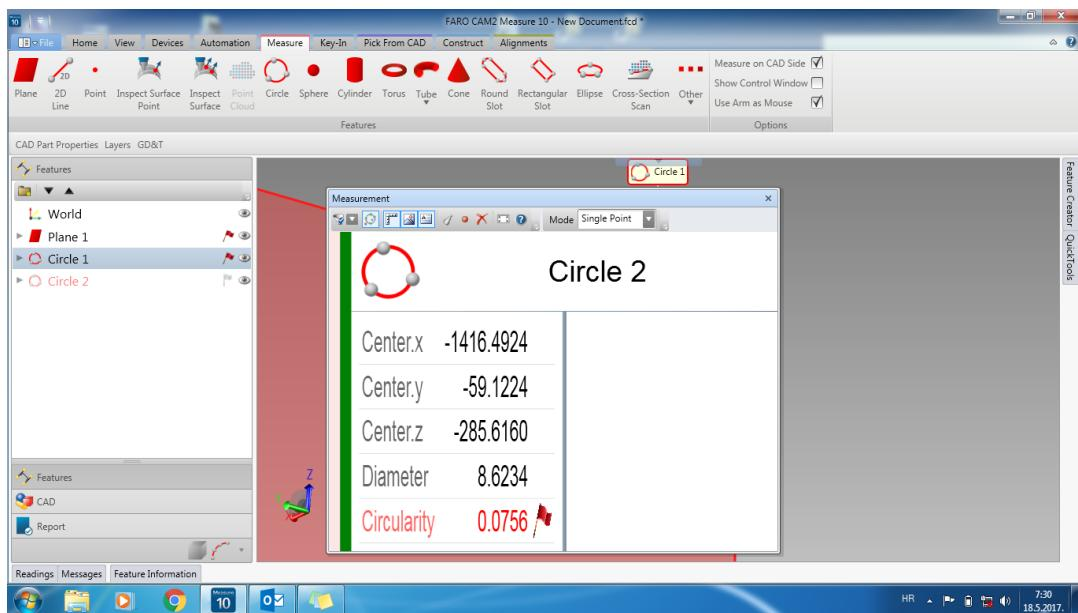
Slika 50. Mjerenje rupe u programu CAM2 Measure
