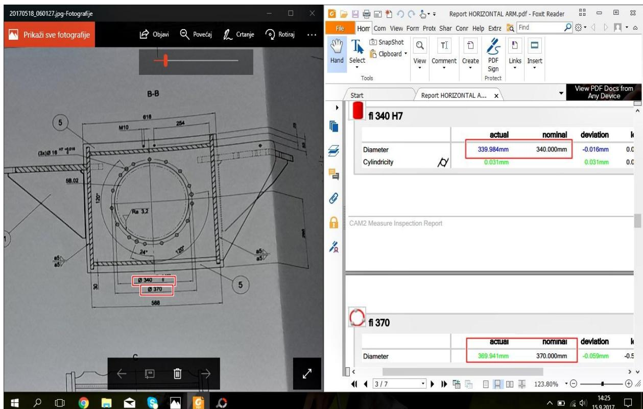
Slika 55. Dokaz točnosti mjerenja cilindra u odnosu na nacrt kupca
