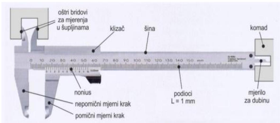
Slika 2. Pomično mjerilo točnosti 0,05 mm [6]
