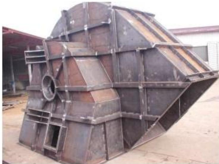
Slika 13. Kućište ventilatora [2]
