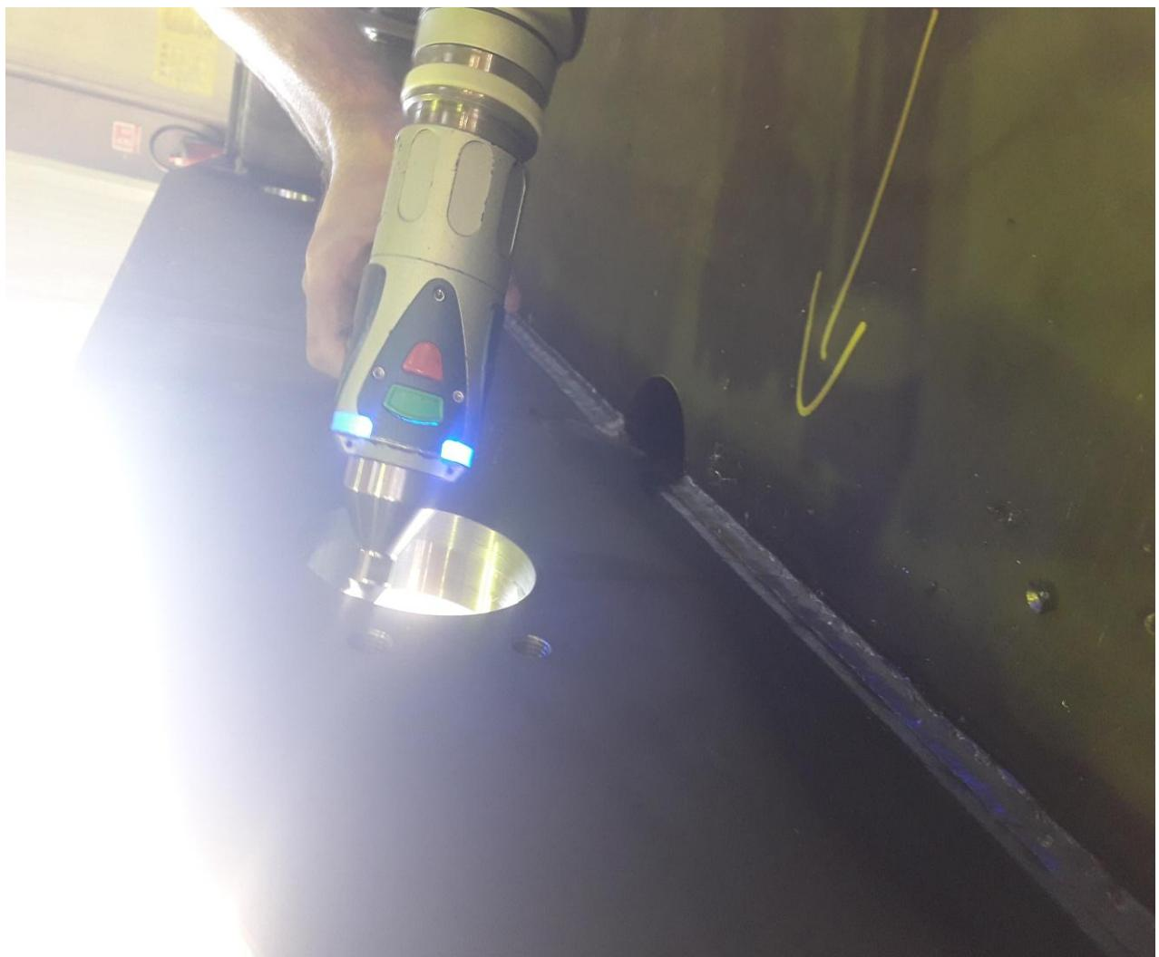
Slika 19. LED diode i tipke na Faro ruci [2]
