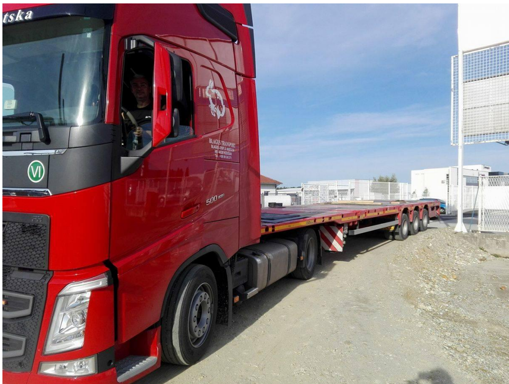
Slika 3.4. Kamion s prikolicom za izvanredni prijevoz
