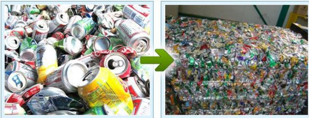
Slika 14. Limenke prije i nakon obrade, Izvor: Izradio autor
