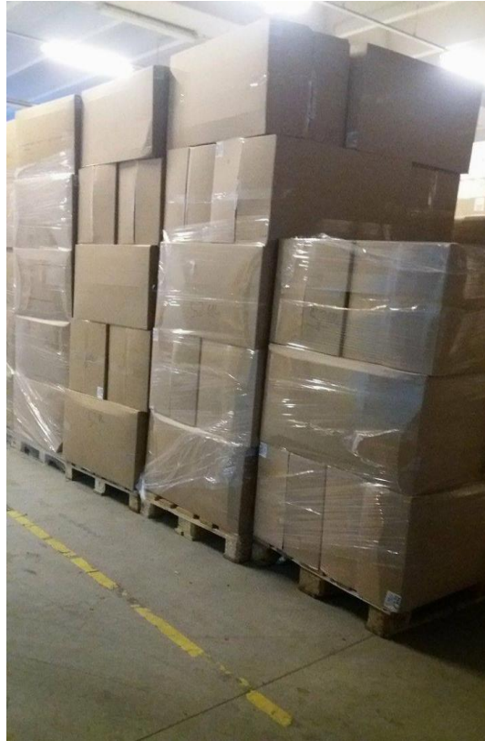
Slika 7. Podno skladištenje u tvrtki Bomark ambalaža d.o.o.
