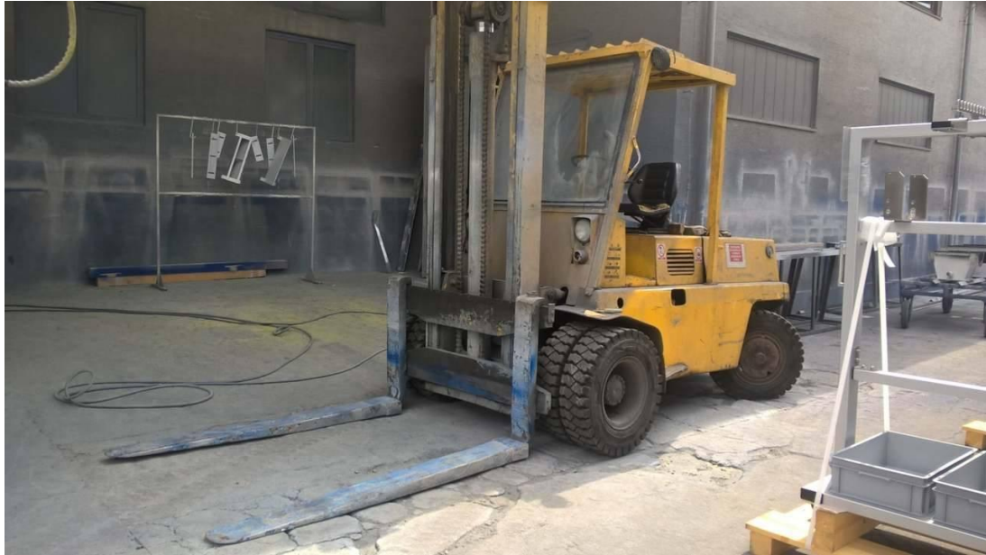
SLIKA 4.8. Čeoni viličar Litostroj 5 t
