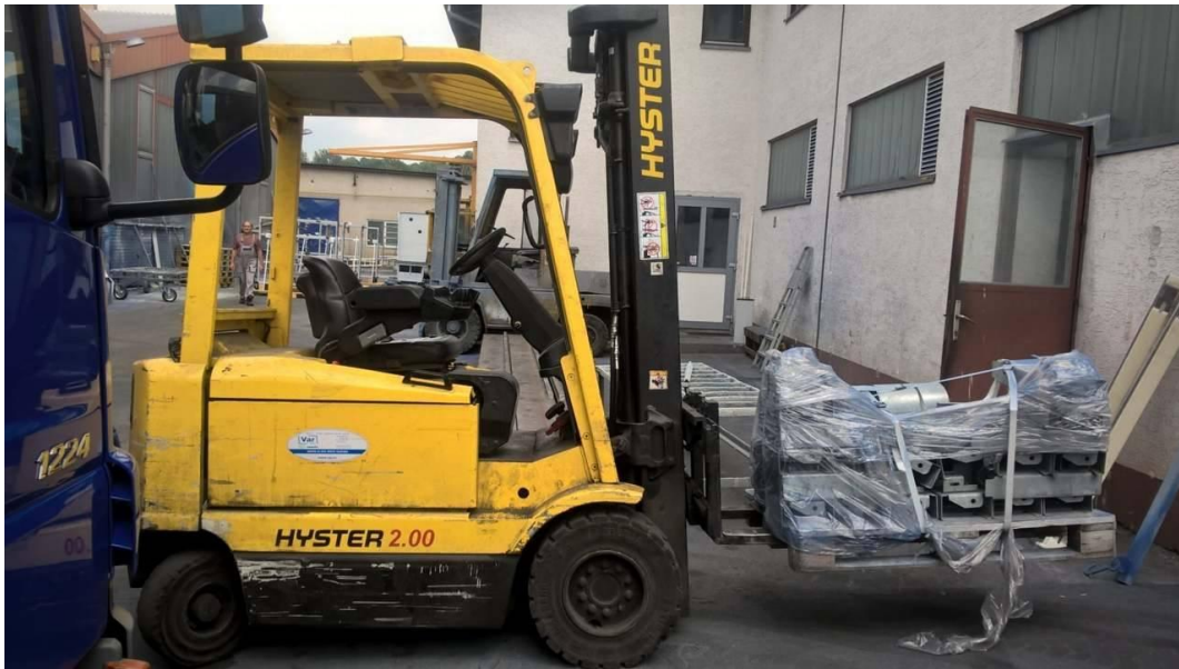
SLIKA 4.11. Čeoni električni viličar Hyster J 2.00 XMT
