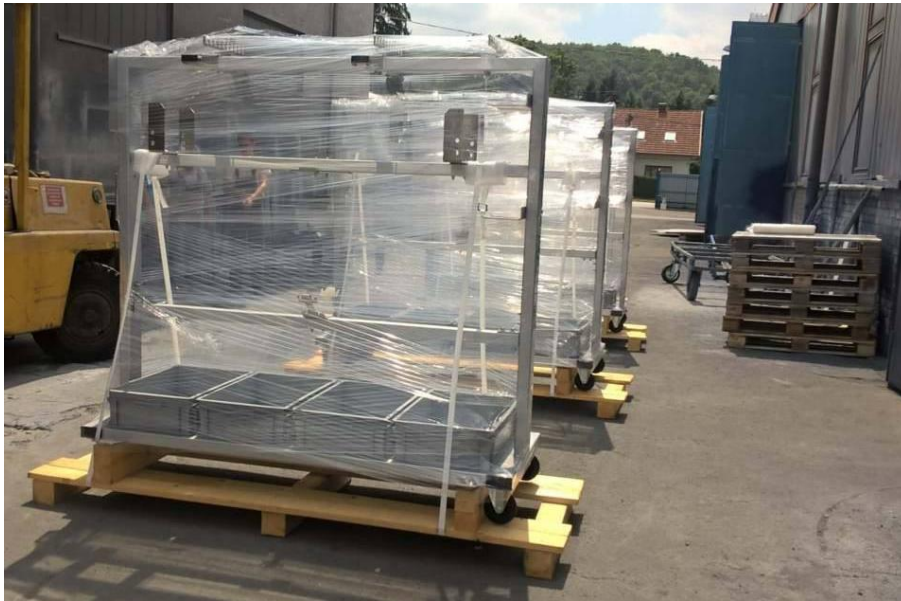
SLIKA 4.5. Primjer izrade palete na kojoj se nalazi roba za otpremu
