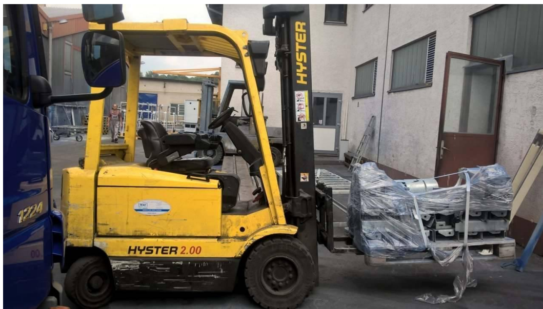
SLIKA 4.11. Čeoni električni viličar Hyster J 2.00 XMT
