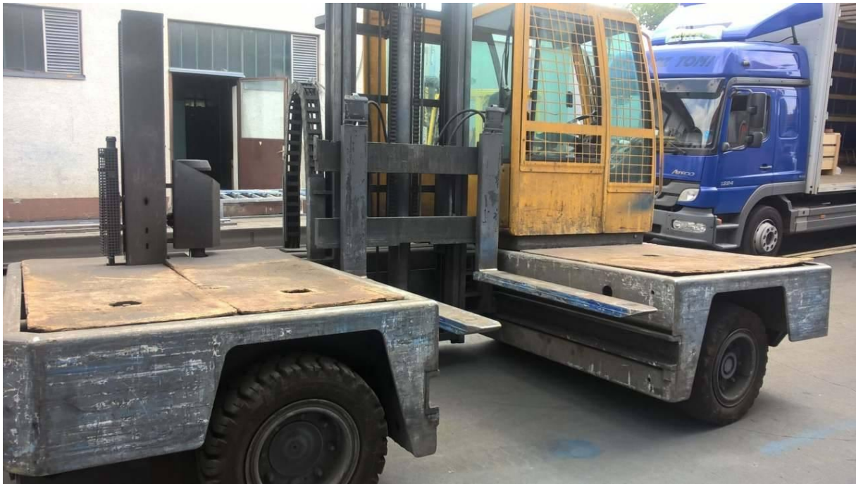
SLIKA 4.10. Bočni viličar Baumann HX50
