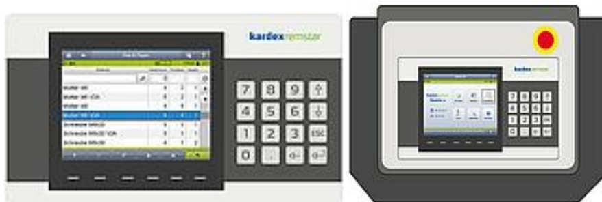
Slika 5.4. Prikaz Logicontrol-a 100 i Logicontrol-a 200 [11]
