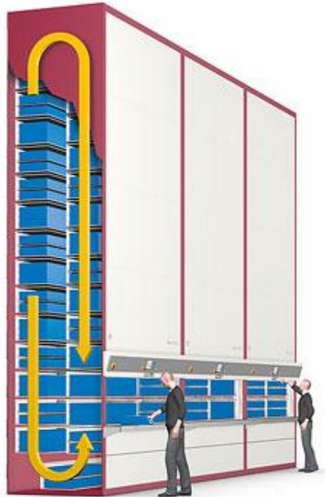
Slika 3.3. Vertikalni karusel [5]
