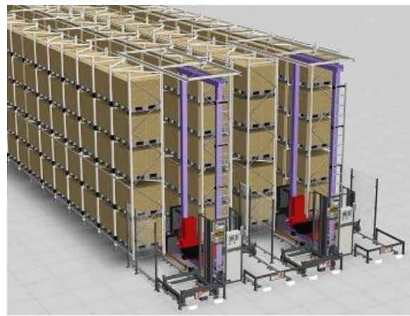
Slika 3.4. Automatizirano visoko regalno skladište ( Unit-Load AS/RS) [31]
