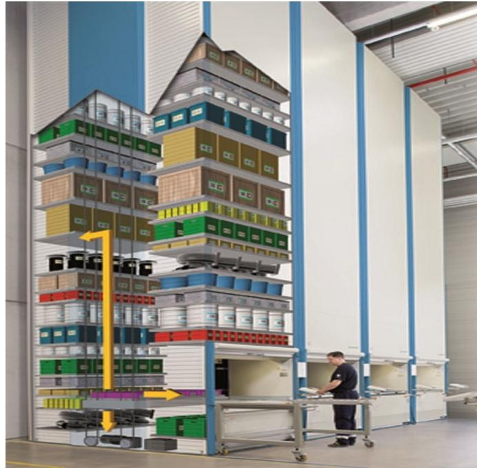
Slika 3.1. Vertikalni podizni modul (VLM) [25]
