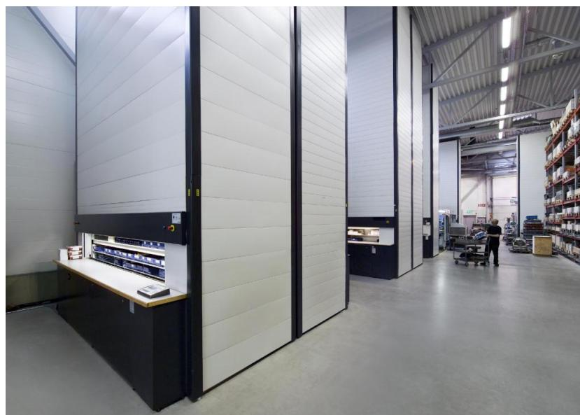
Slika 6.4. Prikaz vertikalnog karusela (Paternoster)
