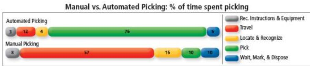
Slika 4.2. Usporedba vremena ručnog i automatiziranog izuzimanja [13]
