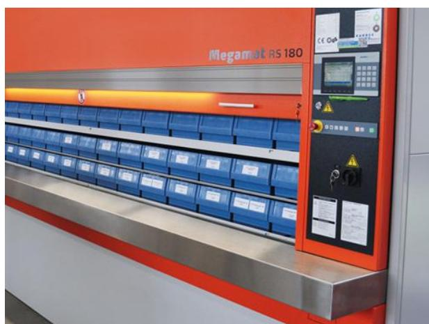
Slika 6.3. Prikaz vertikalnog karusela u tvrtki EKK Anlagentechnik [18]
