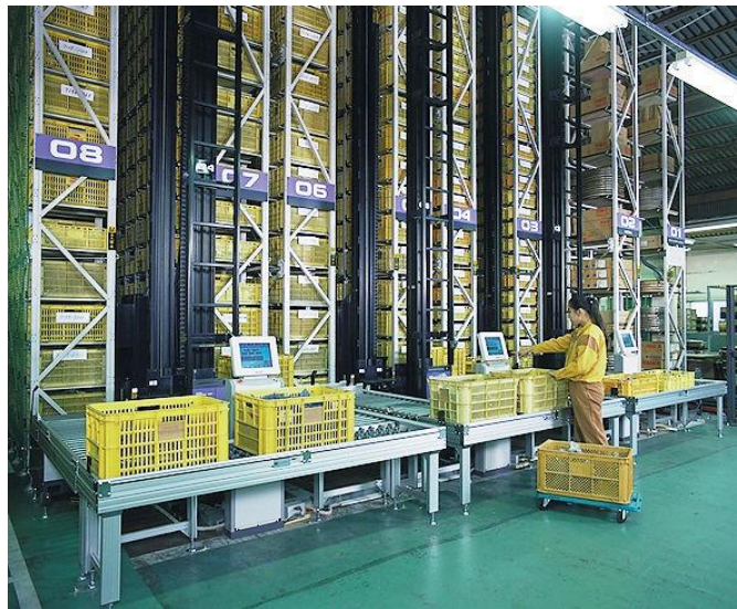
Slika 4.5. Prikaz mini i micro load AS/RS [24]
