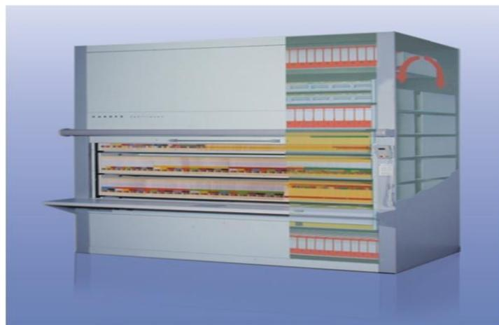
Slika 4. Prikaz vertikalnog karusela [30]
