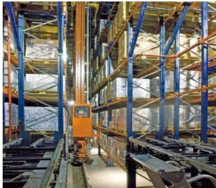
Slika 3.6. Automatizirano skladište za komisioniranje ( Person-on-bord AS/RS) [32]
