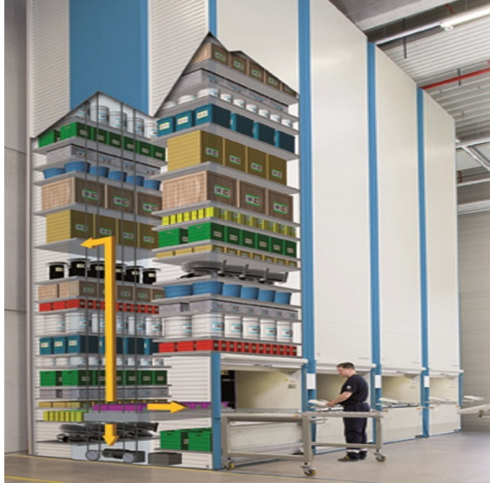
Slika 3.1. Vertikalni podizni modul (VLM) [25]
