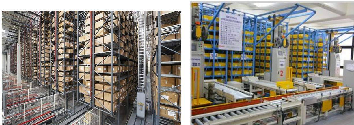
Slika 3.5. Automatizirano skladište za male dijelove ( Mini-Load AS/RS)/(Micro-Load AS/RS) [27]
