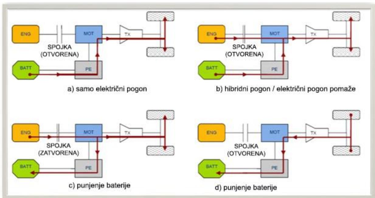
Slika 3.1 Shematski prikaz postojećih hibridnih pogona automobila
