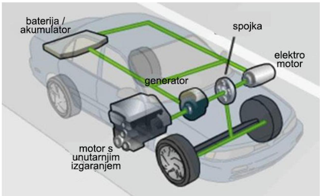
Slika 3.2 Prikaz komponenti najzastupljenije postojće izvedbe hibridnog pogona
