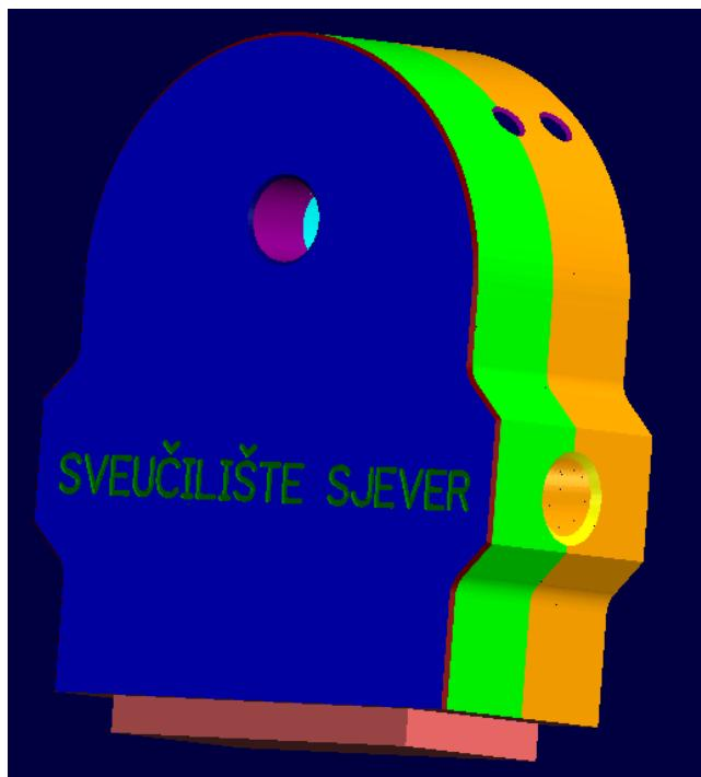
Slika 5.15 Obrađena stezna naprava
