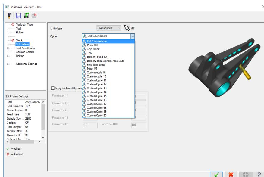
Slika 5.9 Odabir parametra rezanja kod bušenja
