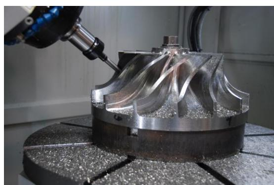
Slika 2.7 Izrada turbine na petoosnoj glodalici
