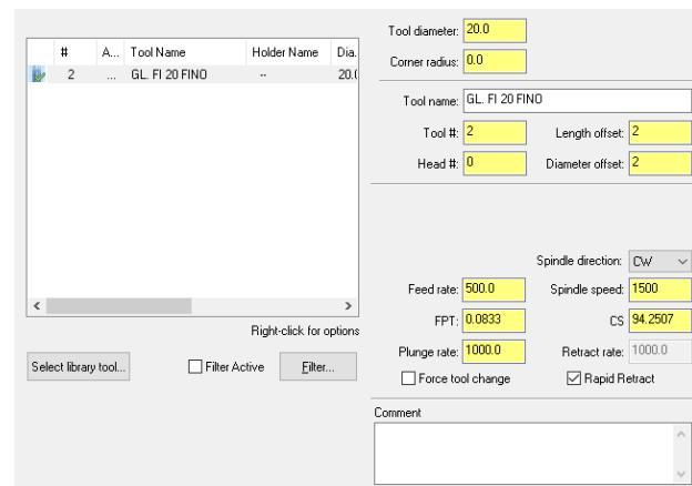
6. Zatim odabiremo izbornik parametra rezanja (cut parameters) i odaberemo lijevu kompenzaciju alata i stavimo 0 na dodatak po z-u i po konturi.
