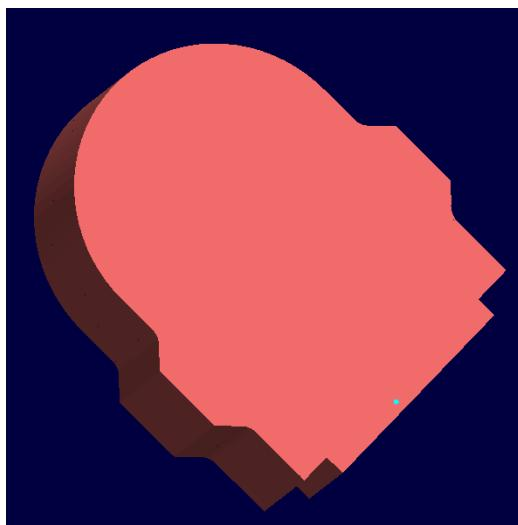
Slika 5.8 Sirovac nakon konturnog glodanja
