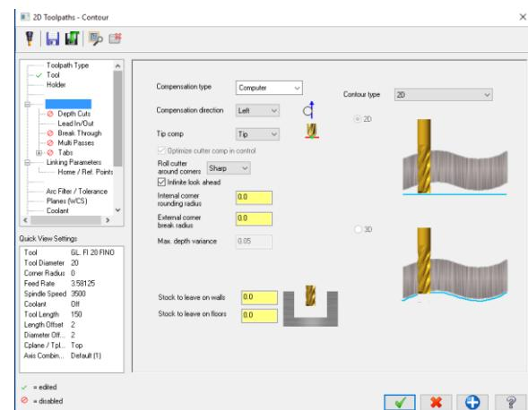
7. Izbornik dubine rezanja (depth cuts) nam omogućuje obradu konture po dubini, znači alat se svaki put spušta za vrijednost koju smo mu zadali sve dok ne dođe do zadane završne dubine. U našem slučaju alat se spušta po 5mm.
