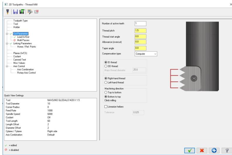
Slika 5.14 Odabir parametra rezanja kod glodanja navoja
