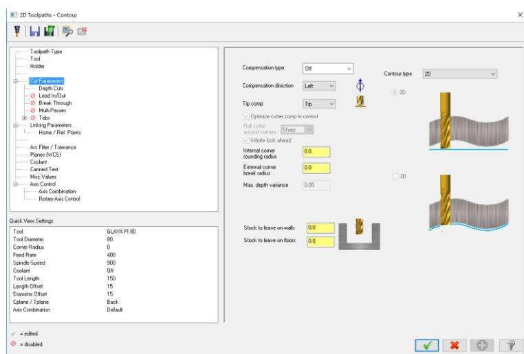
Slika 5.7 Odabir parametra rezanja kod konturnog glodanja
