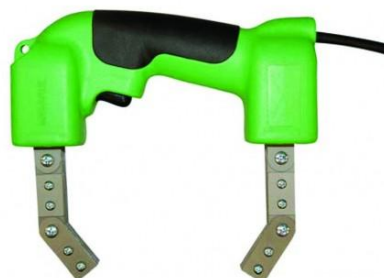
Slika 3.3.3 Elektromagnet za kontrolu magnetnim česticama [2]
