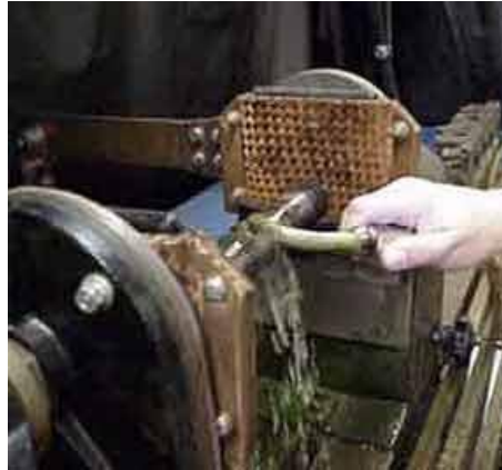
Slika 3.3.7 Ispitivanje magnetskim glavama (direktna magnetizacija) [2]
