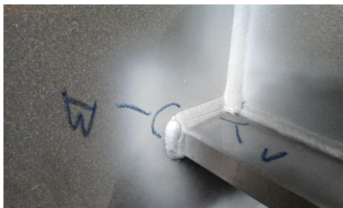
Slika 4.2.3 Navar (desno - oznaka V) zbog premalog unosa topline i neobrađeni završetak zavora ( lijevo – oznaka B)
