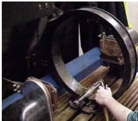
Slika 3.3.8 Ispitivanje zavojnicom (indirektna magnetizacija) [2]
