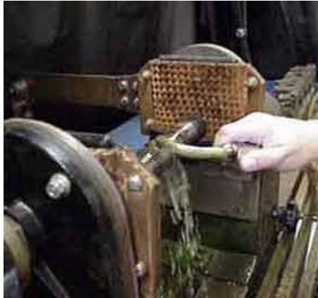
Slika 3.3.7 Ispitivanje magnetskim glavama (direktna magnetizacija) [2]
