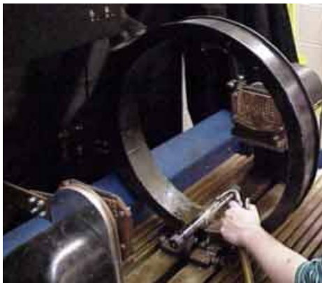
Slika 3.3.8 Ispitivanje zavojnicom (indirektna magnetizacija) [2]
