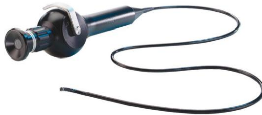
Slika 3.1.3 Fiberskop Izvor: www.schoelly-latinamerica.com
