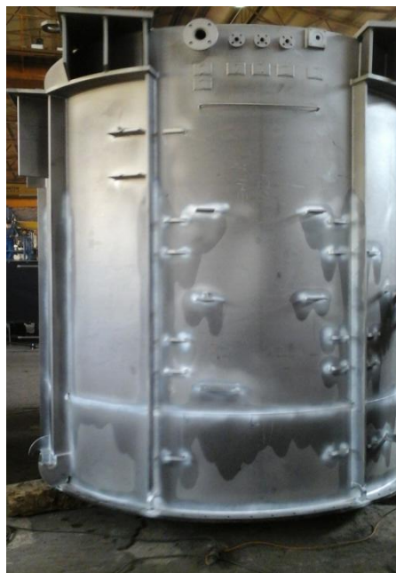
Slika 4.1.4 Prednja strana transformatorskog kotla s zavarima prekrivenim temeljnom bojom
