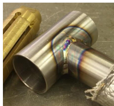
Slika 3.4 Spoj cijevi MIG zavarivanjem [6]
