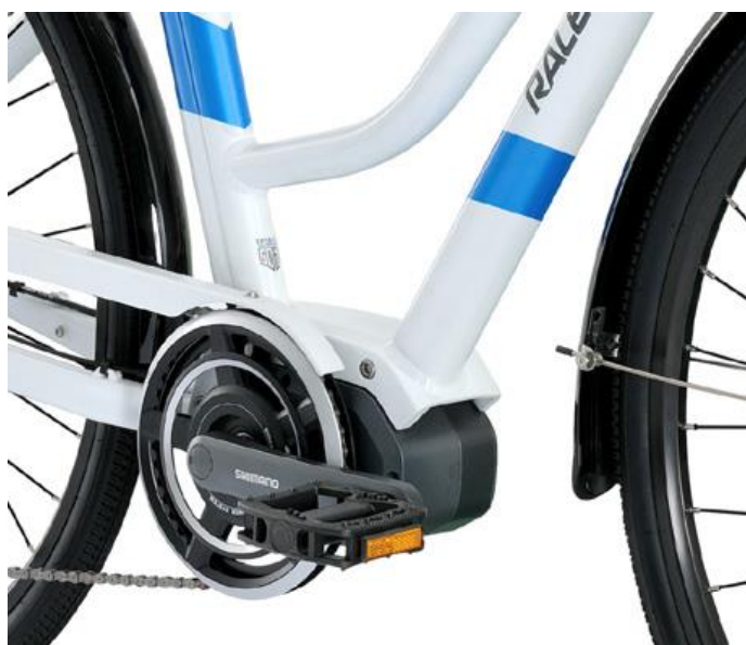
Slika 2.11 Prikaz mid drive motora[3]
