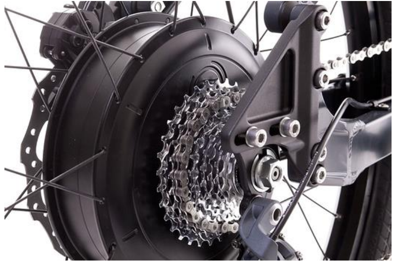
Slika 2.9 Prikaz direktnog hub motora [3]
