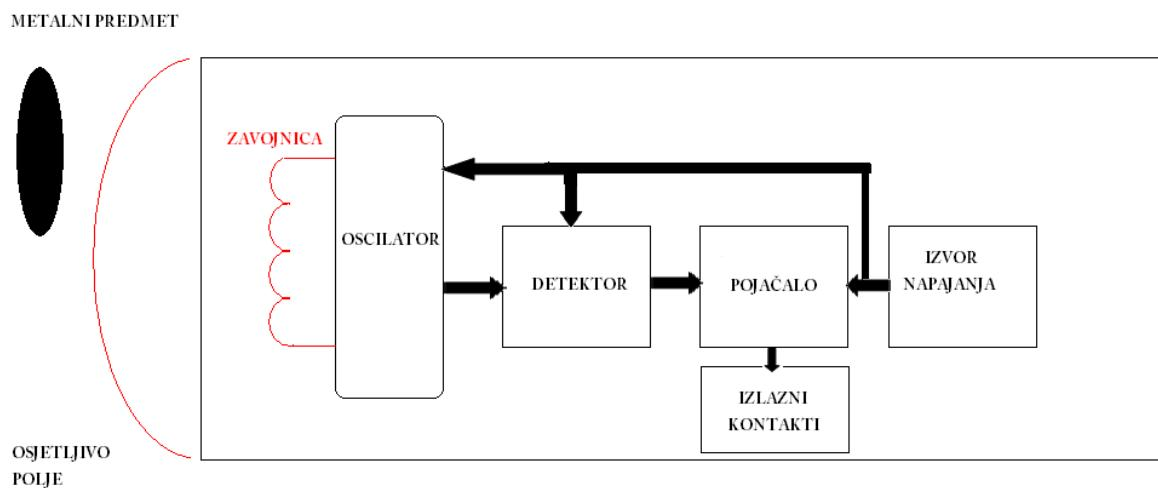
Slika 2. 3 Prikaz rada induktivnog osjetila blizine
