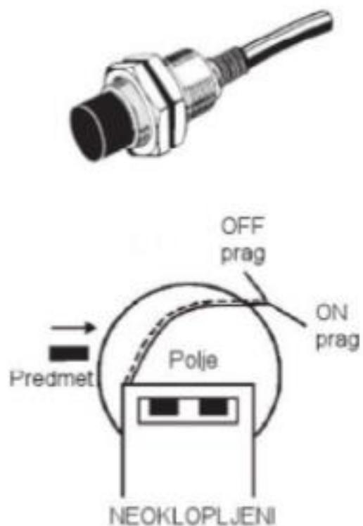
Slika 2. 6 Prikaz neoklopljenog induktivnog osjetila [1]
