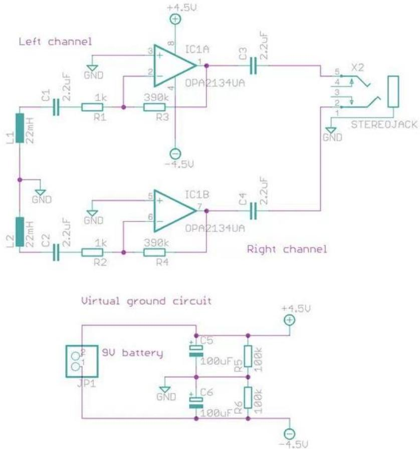
Slika 3. 5 Električna shema detektora magnetskog polja [13]
