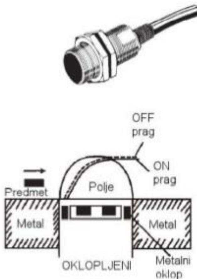
Slika 2. 5 Prikaz oklopljenog induktivnog osjetila [1]
