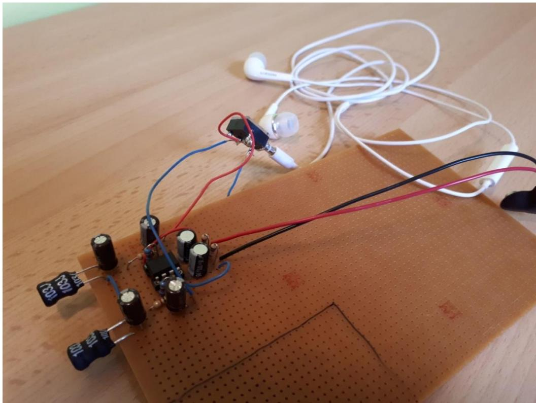
Slika 3. 6 Osjetilo za detektiranje elektromagnetskog zračenja
