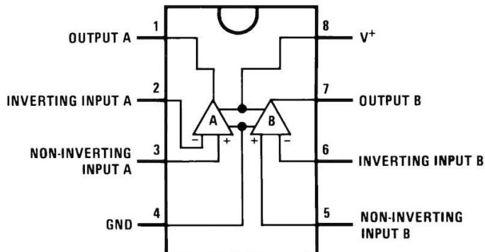
Slika 3. 10 Raspored pinova diferencijalnog pojačala LM358 [9]
