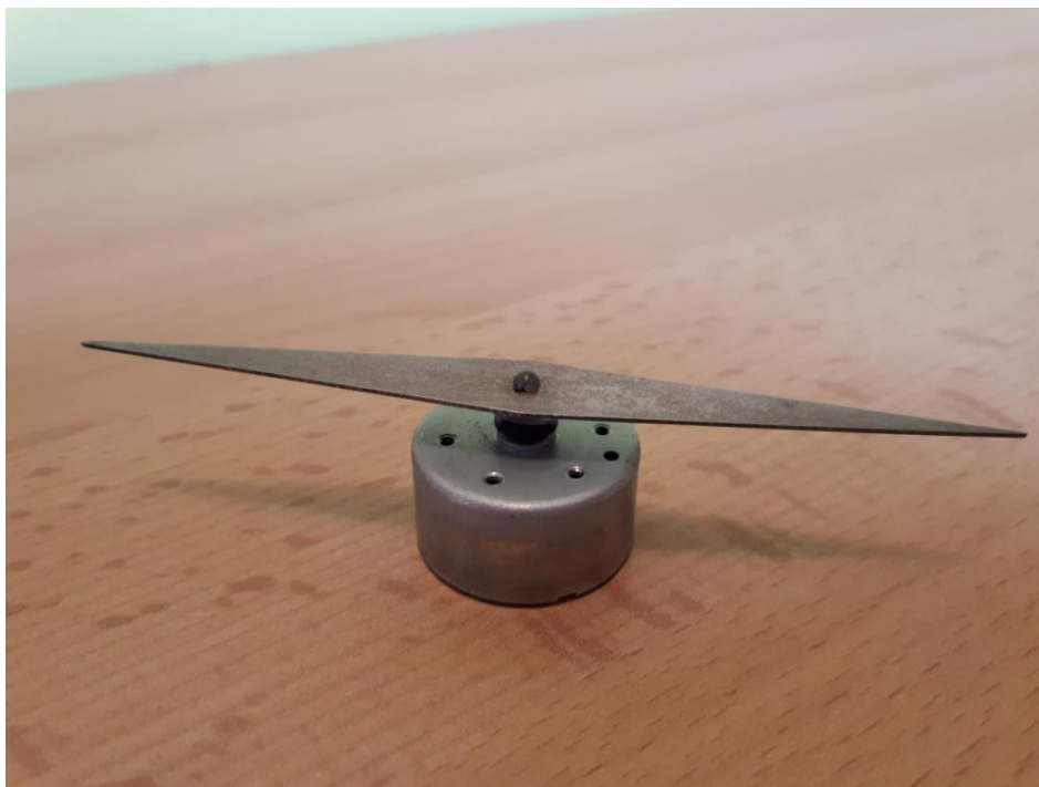
Slika 3. 3 Montirana igla na elektromotoru
