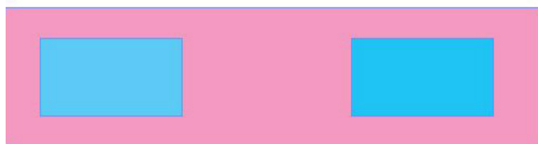
Slika 8.2. Testni uzorak efekta nabiranja sa sekundarnim stimulusom 50% RTV i primarnim stimulusom 55% i 65% RTV
