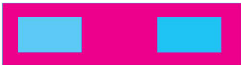
Slika 8.4. Testni uzorak efekta nabiranja sa sekundarnim stimulusom 100% RTV i primarnim stimulusom 55% i 65% RTV
