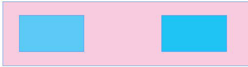
Slika 8.1 Testni uzorak efekta nabiranja sa sekundarnim stimulusom 25% RTV i primarnim stimulusom 55% i 65% RTV
