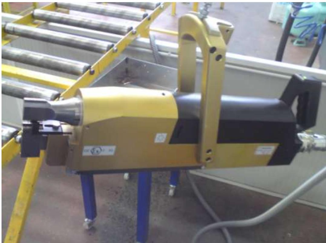
Slika 3.3.2.Uređaj za ultrazvučno zavarivanje
