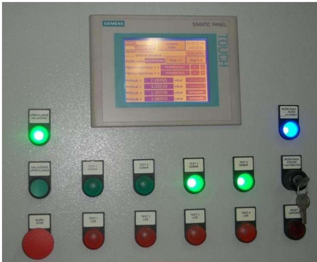
Slika 3.2.1.Kontrolna ploča kontrole vakumiranja
