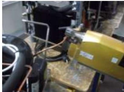
*Slika 4.5.Uređaj za ultrazvučno zavarivanje*
