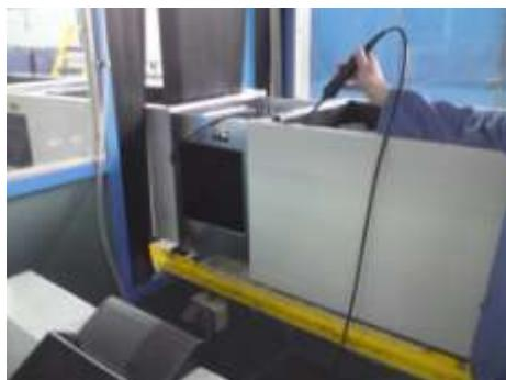
*Slika 4.6.Ispitivanje nepropusnosti*
