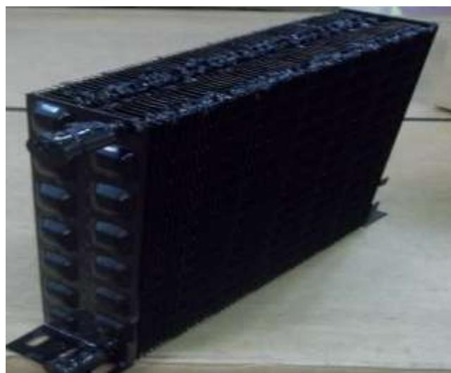
*Slika 2.1.3.1.1.Čelični isparivač*
