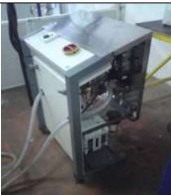
Slika 4.1. VACON 1 – stroj za vakuumiranje
