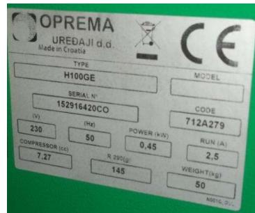
Slika 4.16. Naljepnica ispitivanog uređaja
