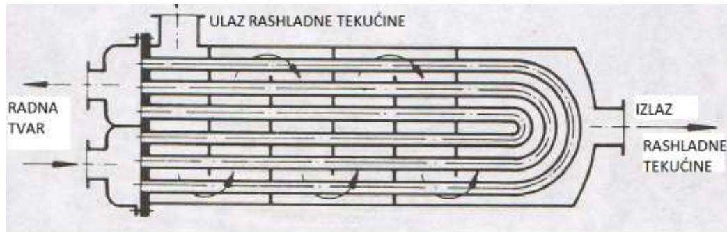
Slika 2.1.3.1.2. Isparivač sa snopom cijevi za suho isparavanje
