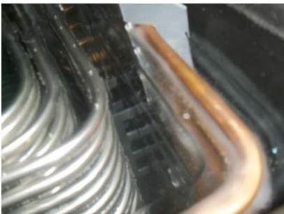
Slika 4.14. Stvaranje leda prilikom mokrog ispitivanja
