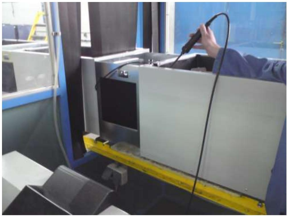
*Slika 3.6.2.Ispitivanje nepropusnosti*
