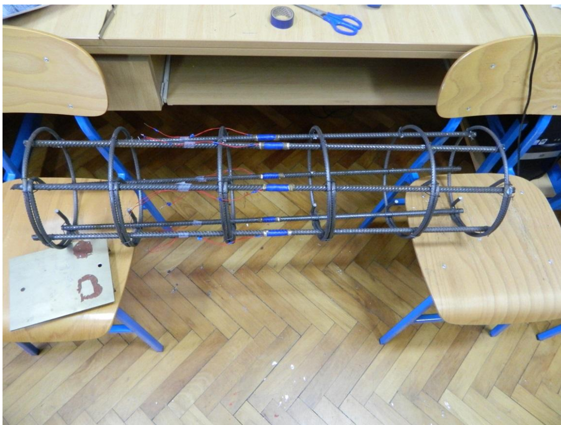
Slika 3. 12 Armaturni koš s instaliranim tenzometrima
