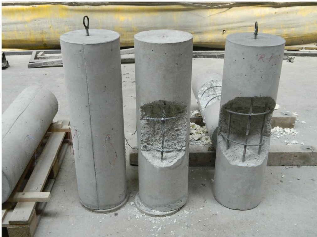
Slika 4. 13 Usporedni prikaz sprijeda tri tipa oštećenja modela
