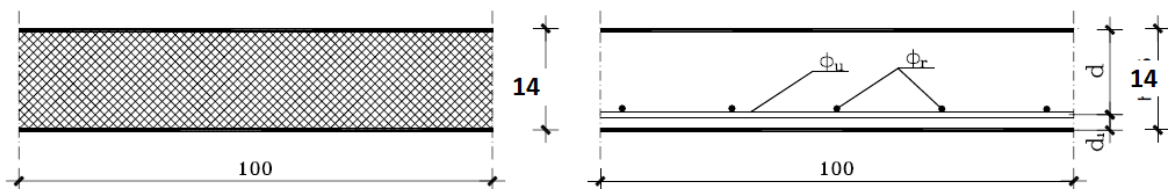
Slika 14. Poprečni presjek ploče, statička visina presjeka
