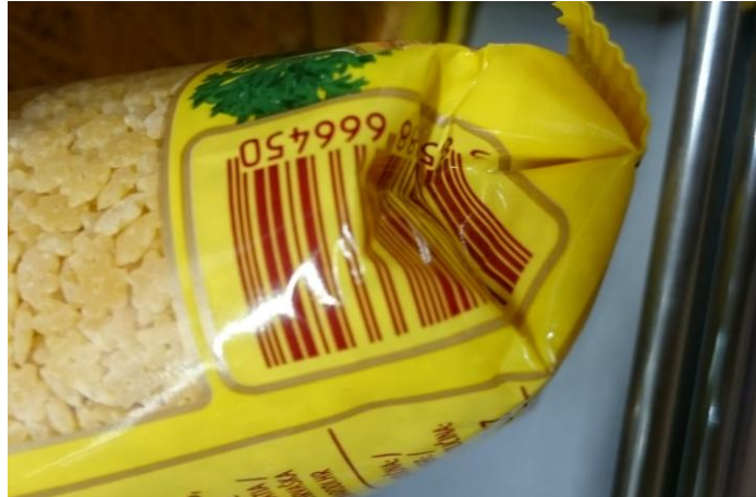
Slika 4.16. Pakiranje tjestenine u tankoj, savitljivoj vrećici
