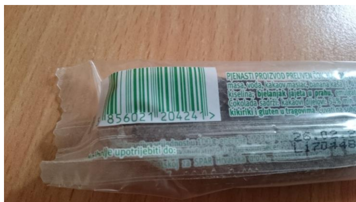
Slika 4.18. Bar kod podložan gnječenju
