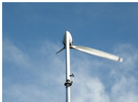
Slika 4.6 Vjetroturbina s jednom lopaticom[20]
