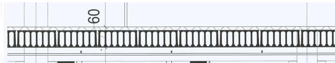
Slika 6.6. Detalj presjeka kroz stropnu konstrukciju
