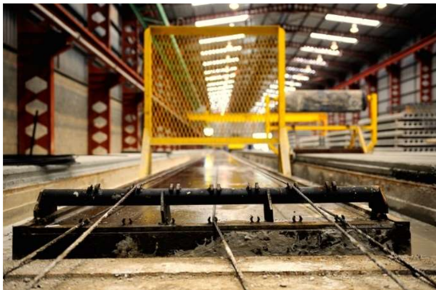
Slika 3.2. Prednapeto uže za šuplje ploče
