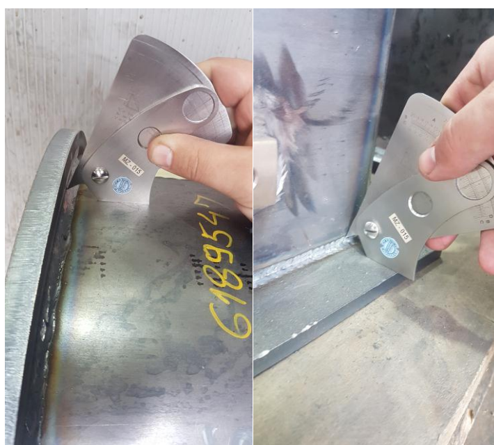
Slika 50. Kontrola visine zavara
