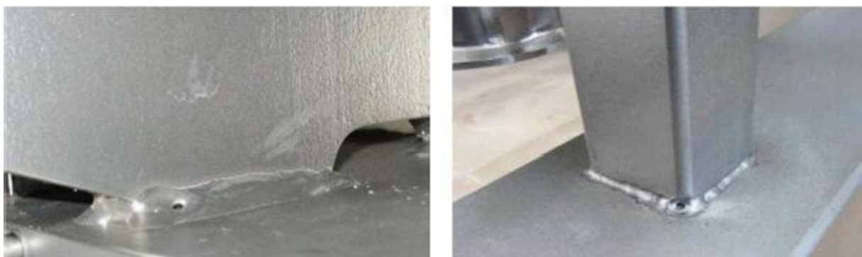
Slika 39. Pojedinačne pore i rupe u zavaru
