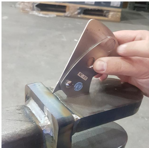
Slika 32. Kontrola dimenzija zavarenog spoja
