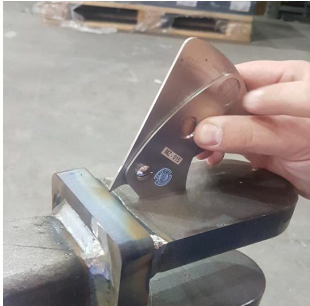
Slika 32. Kontrola dimenzija zavarenog spoja
