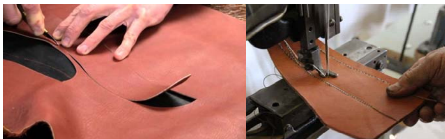
Slika 19. Primjeri izrezivanja i šivanja
